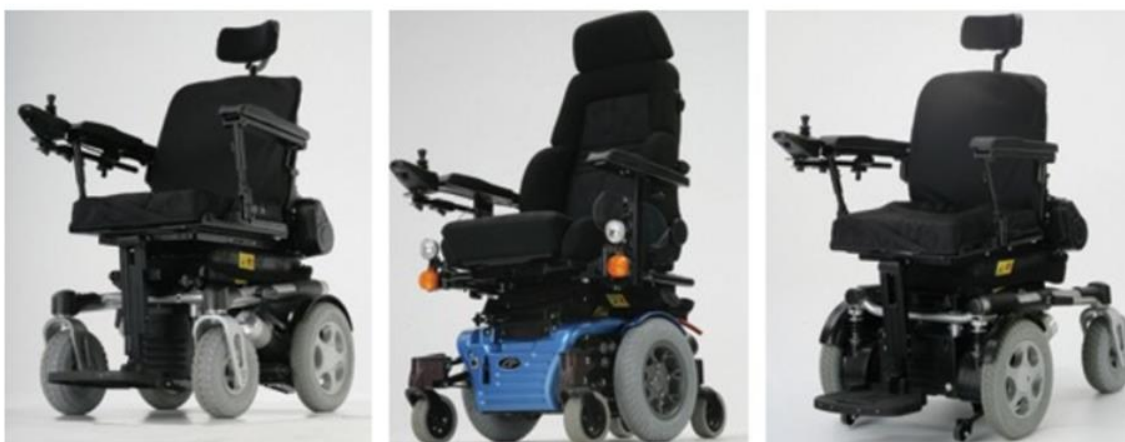
Slika 4. Podjela elektromotornih invalidskih kolica prema položaju pogonskih kotača [5]
