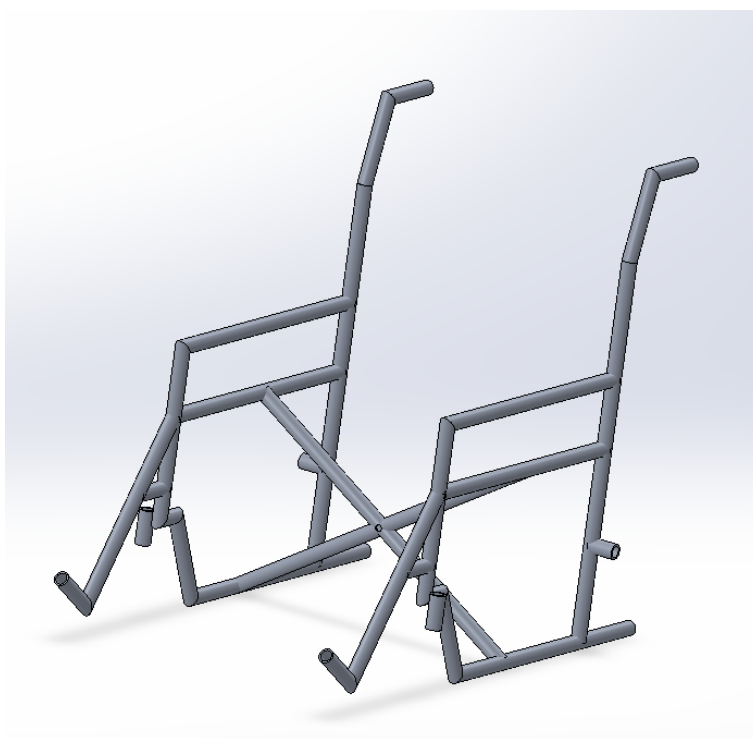
Slika 29. Model okvira invalidskih kolica za numeričku analizu
