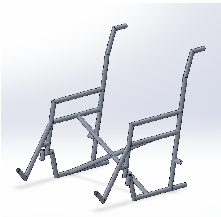
Slika 29. Model okvira invalidskih kolica za numeričku analizu
