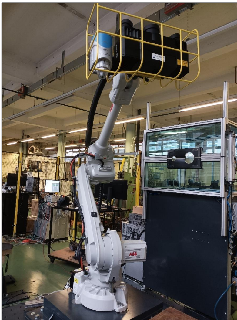
Slika 2. Prikaz mjernog uređaja montiranog na robot i spremnika
