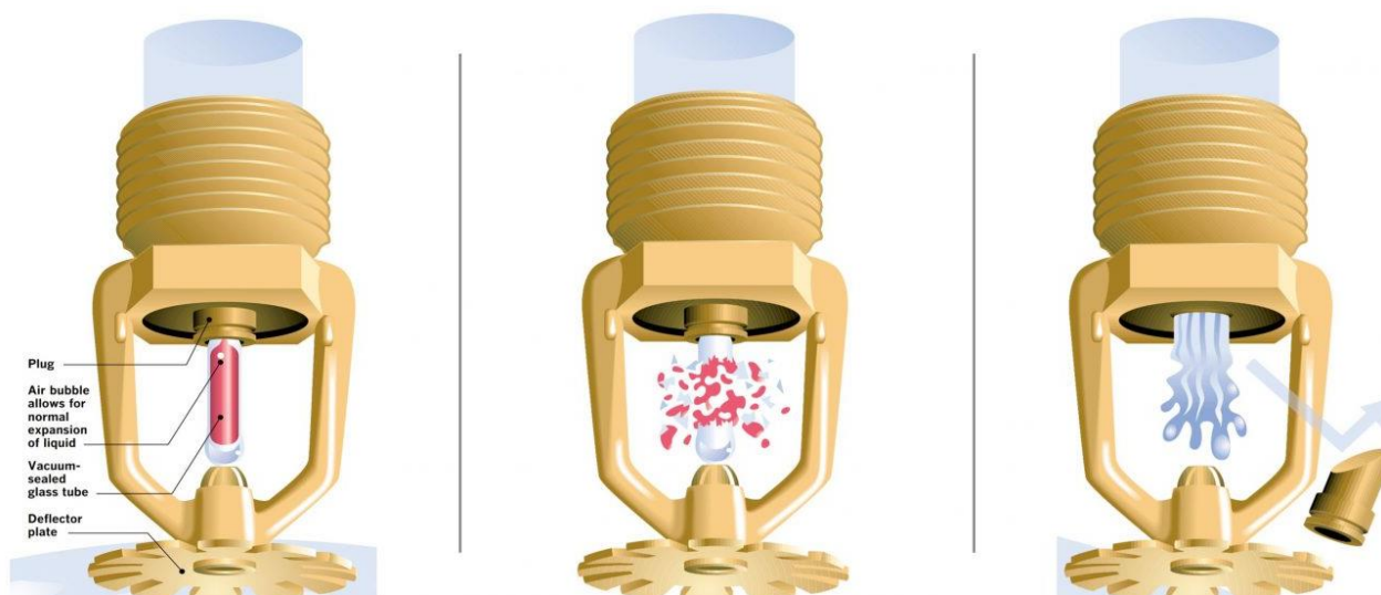
Slika 2.4 Aktivacija prskalice uslijed povišene temperature [7]
