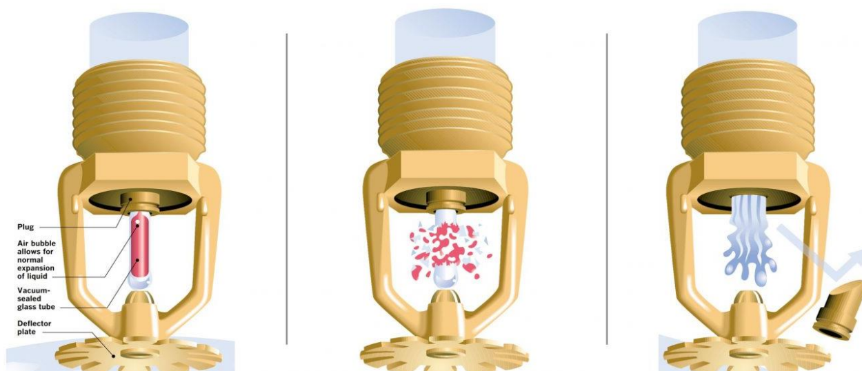
Slika 2.4 Aktivacija prskalice uslijed povišene temperature [7]
