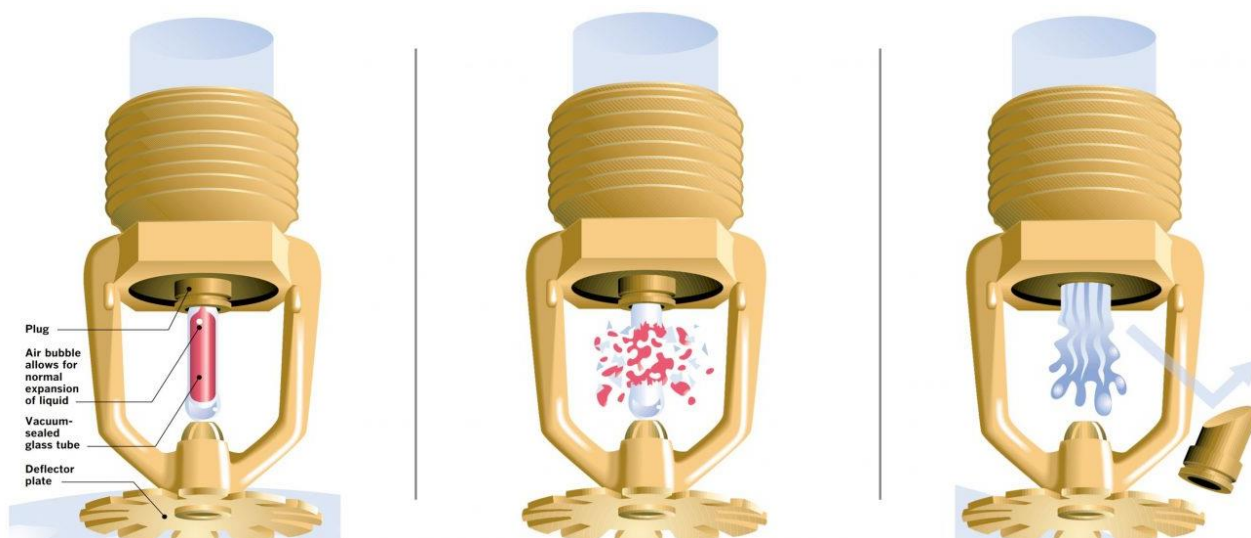
Slika 2.4 Aktivacija prskalice uslijed povišene temperature [7]
