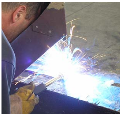
Slika 52. Zavarivanje ispitnih uzoraka.
