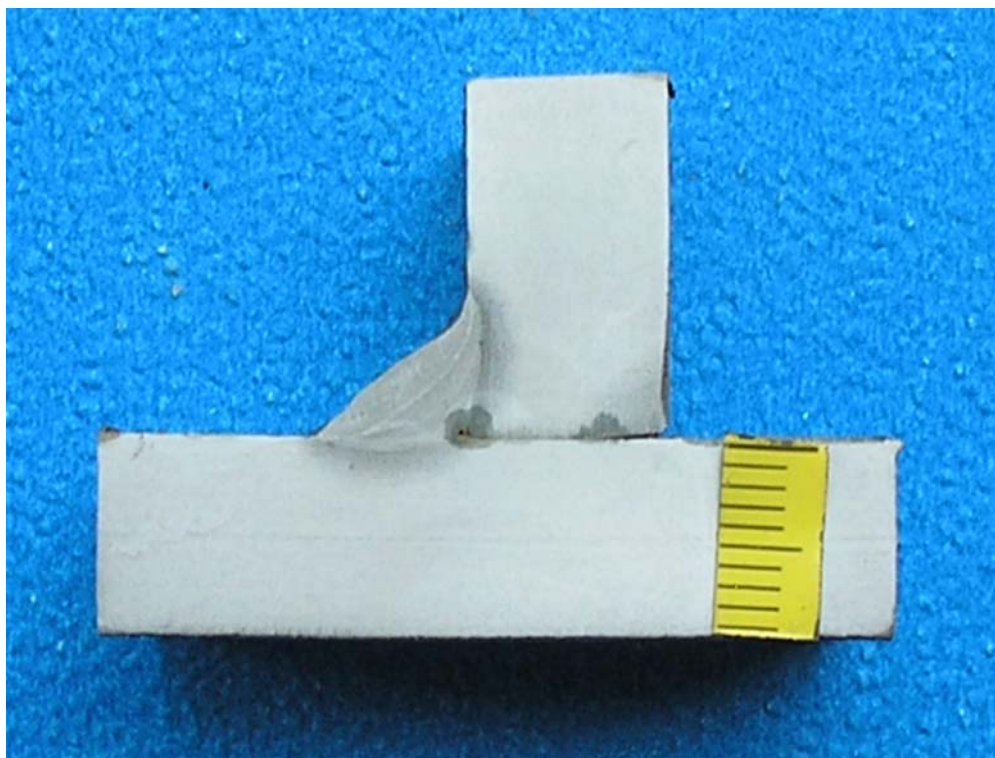
Slika 58. Izgled makro izbruska ispitnog uzorka zavarenog REL postupkom u 1 prolazu; I_z = 90 - 120 \text{ A} , U_z = 48 - 50 \text{ V} .
