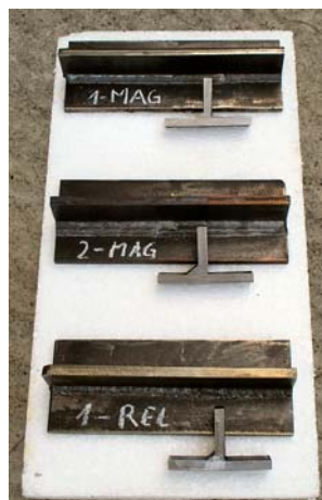
Slika 55. Ispitni uzorci nakon izrezivanja.
