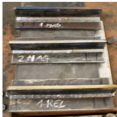
Slika 53. Ispitni uzorci nakon zavarivanja.
