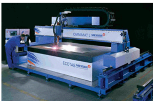
Slika 26. Automatizirana plinska rezačica [27].
