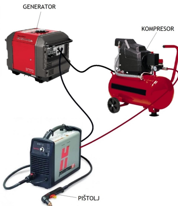
Slika 2 Dijelovi potrebni za rezanje plazmom
