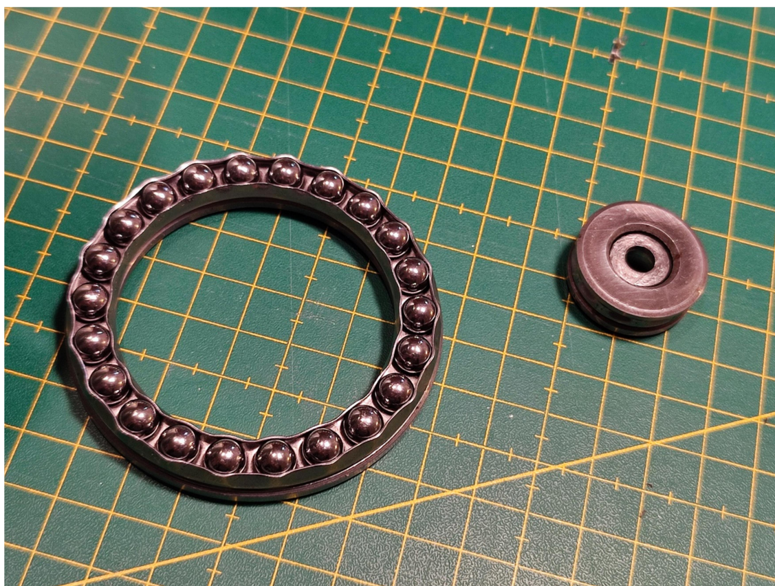
Slika 31 Ležajevi korišteni u rotacijskom dijelu
