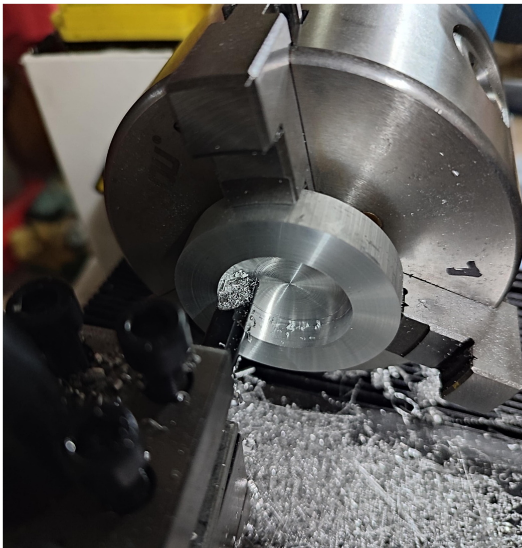
Slika 33 Izrada ležajnih mjesta, istokarivanje (crtež broj 01-01-02)
