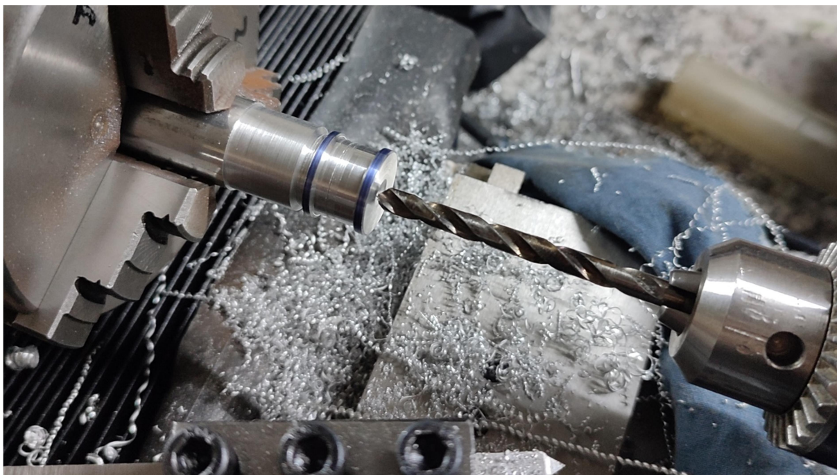
Slika 28 Bušenje provrta u remenici za natezanje (crtež broj 01-02-04)
