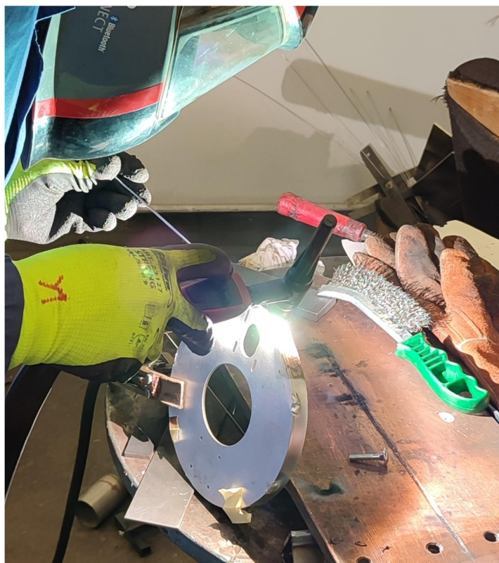
Slika 23 Zavarivanje zaštite na bazu rotacijskog dijela stroja (crtež broj 01-02-01)
