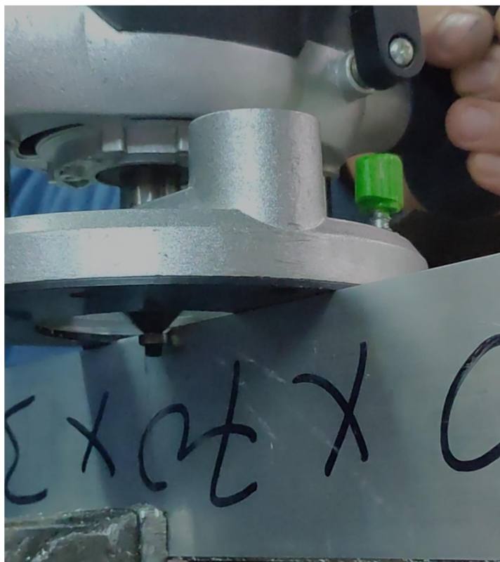
Slika 16 Izrada skošenja na pokretnoj ruci
