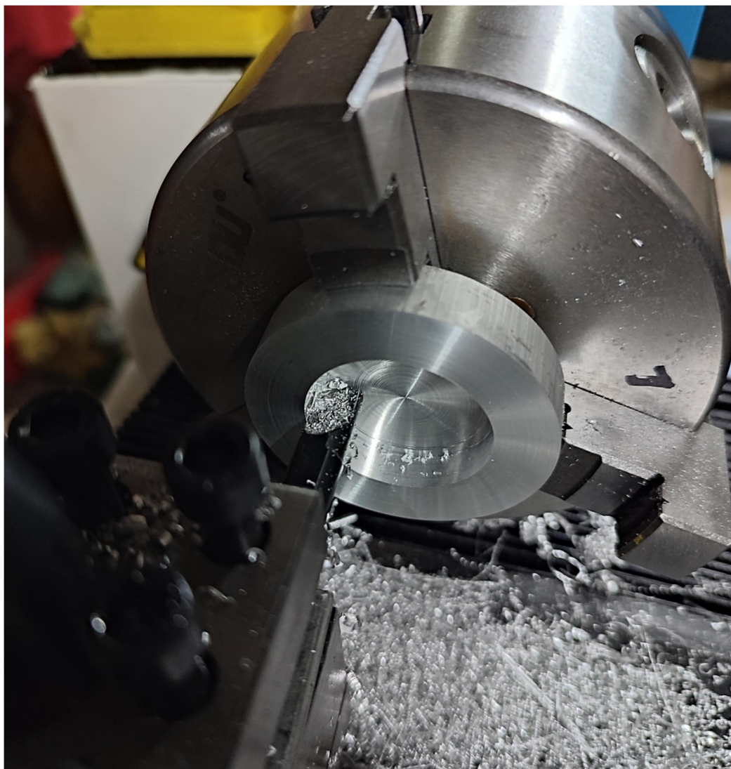
Slika 33 Izrada ležajnih mjesta, istokarivanje (crtež broj 01-01-02)
