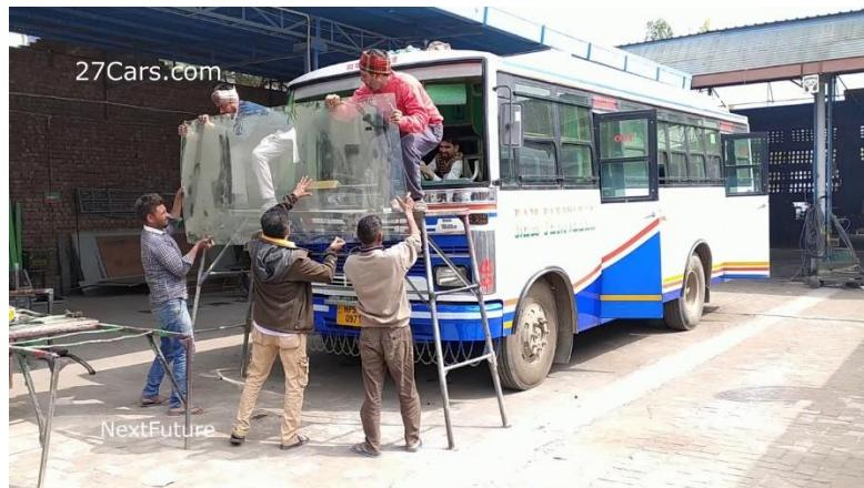
*Slika 2.3. Postavljenje vjetrobranskog stakla na autobus [6]*
