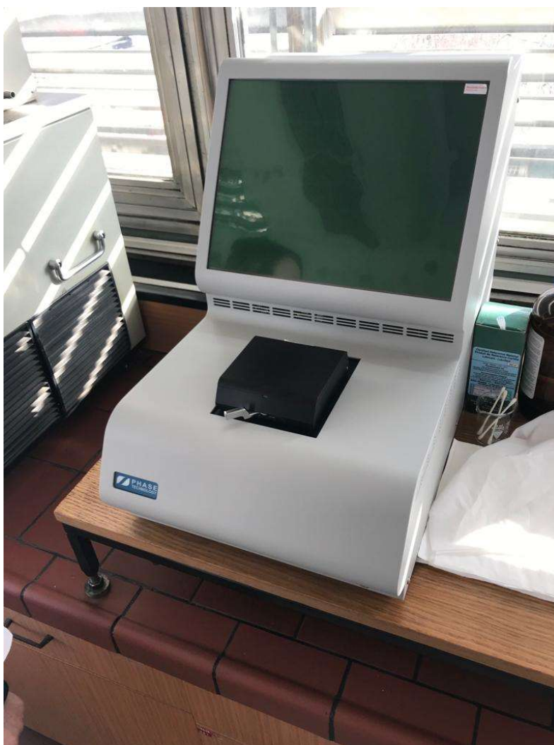
Slika 12. Automatski uređaj za određivanje točke tečenja
