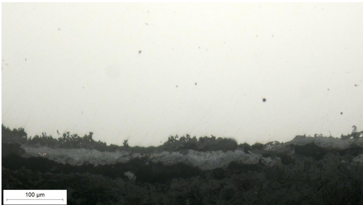
Slika 22. Vanjski rub poprečnog presjeka stijenke kalupa, snimljen pri povećanju 200×
