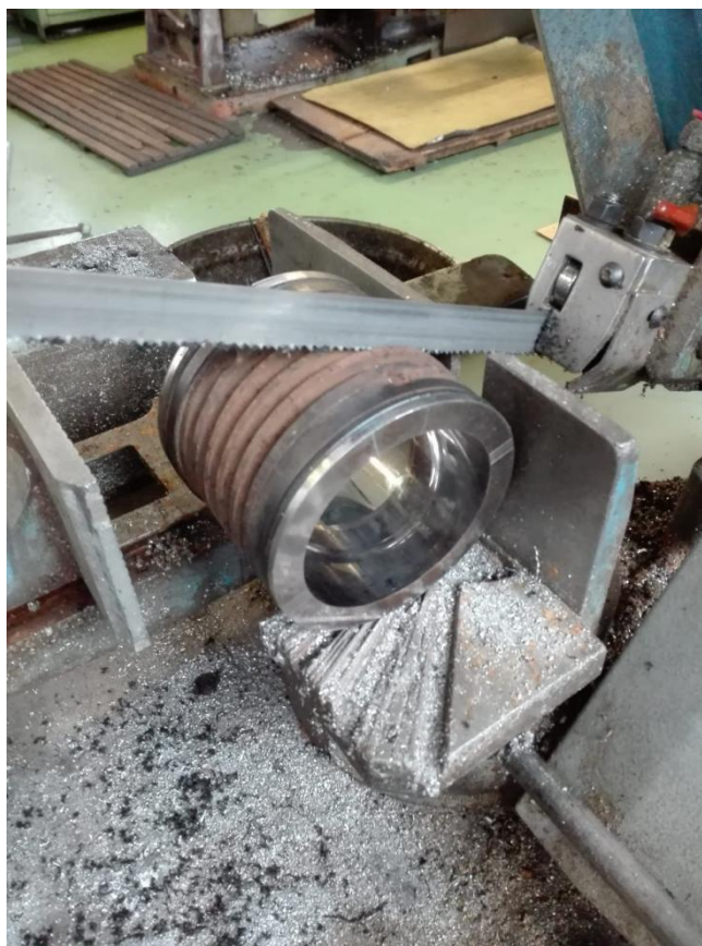
Slika 12. Izrezivanje uzoraka na tračnoj pili
