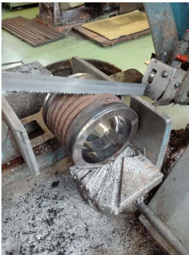
Slika 12. Izrezivanje uzoraka na tračnoj pili
