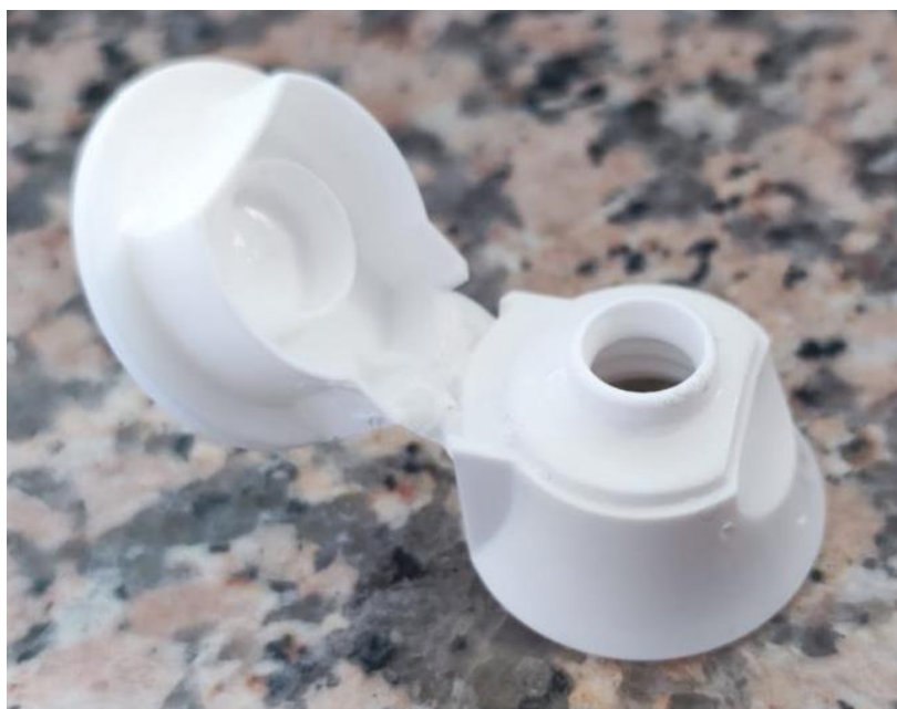
Slika 1. Poklopac od polipropilena dobiven injekcijskim prešanjem
