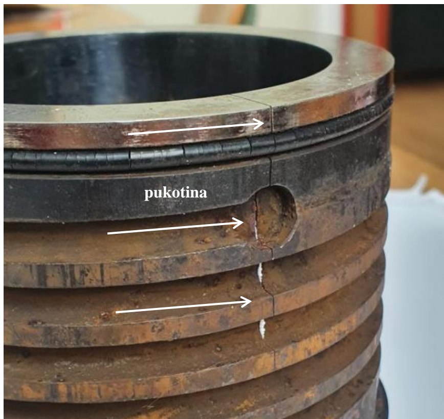
Slika 11. Mjesto na kojem su uzeti uzorci za analizu mikrostrukture
