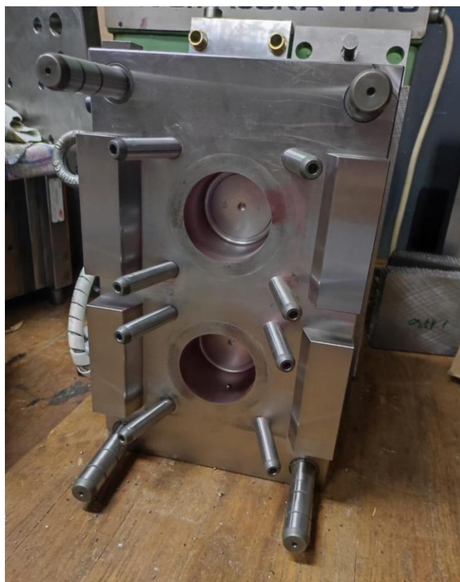
Slika 6. Nepomični dio kalupa za injekcijsko prešanje
