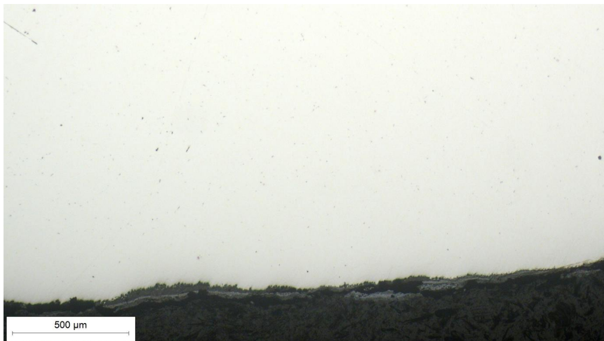
Slika 21. Vanjski rub poprečnog presjeka stijenke kalupa, snimljen pri povećanju 50×
