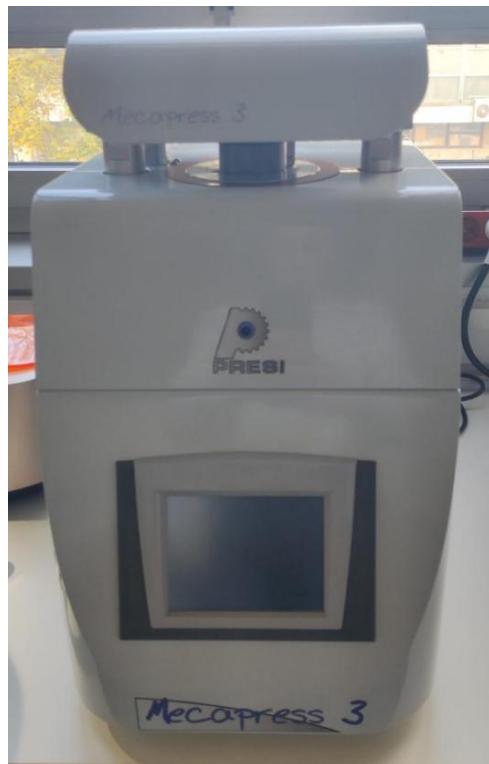
Slika 15. Pneumatska preša Mecapress 3
