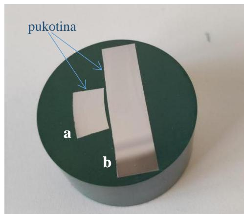
Slika 16. Metalografski uzorak nakon vađenja iz preše
