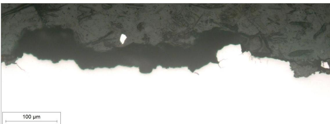
Slika 20. Poprečni presjek kroz stijenku kalupa uz rub pukotine, snimljen pri povećanju  $200\times$
