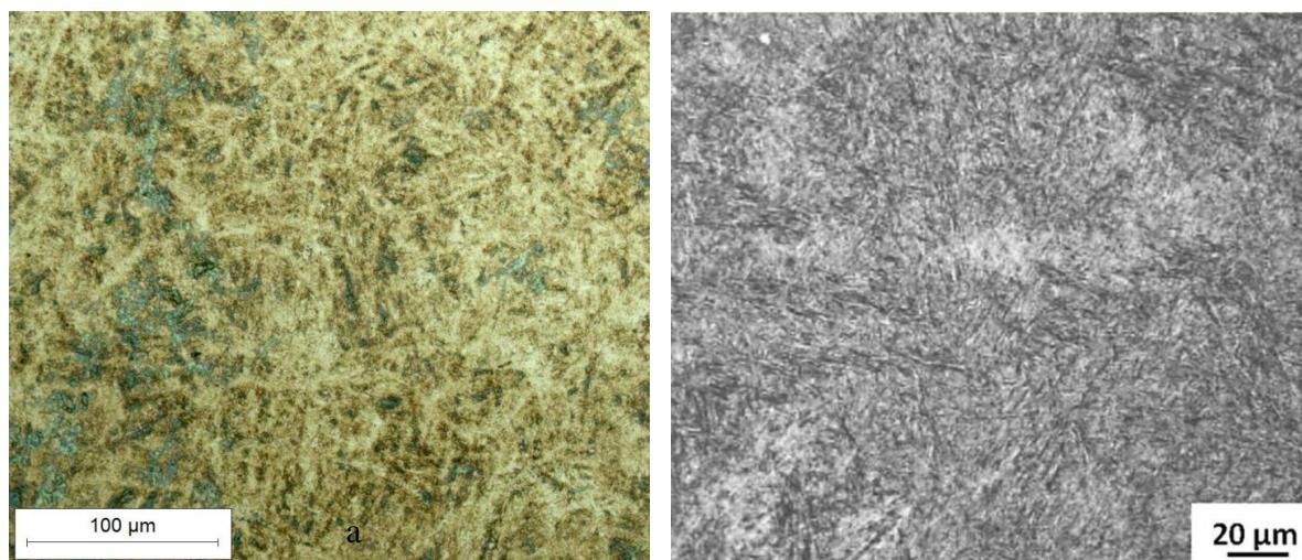
Slika 39. Usporedba mikrostrukture matice kalupa (a) s mikrostrukturom iz literature [19]
