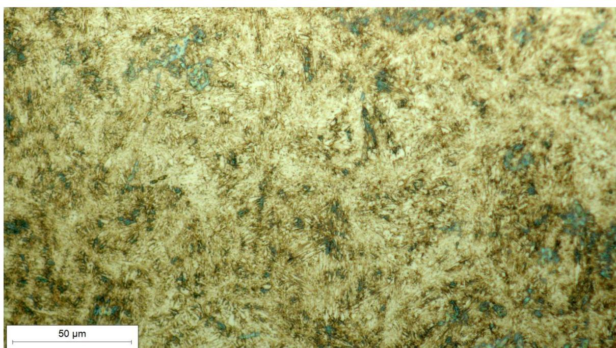
**Slika 31.** Mikrostruktura poprečnog presjeka stijenke matrice u sredini, snimljeno pri povećanju  $500\times$
