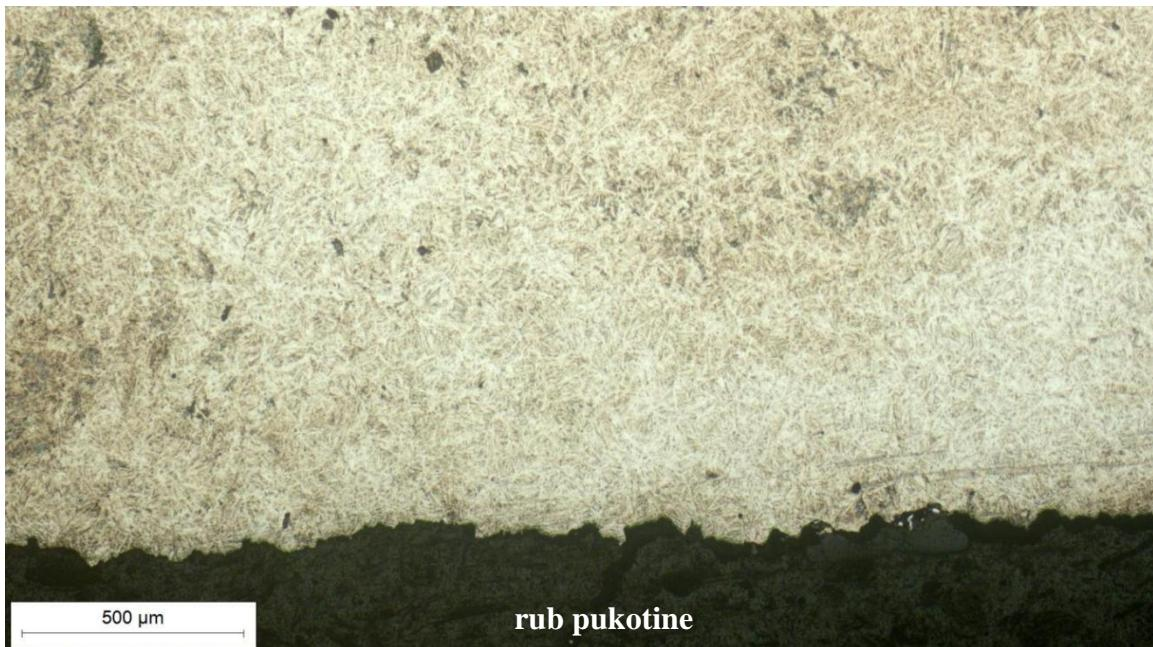
Slika 32. Mikrostruktura uzdužnog presjeka stijenke matrice uz rub pukotine, snimljeno pri povećanju  $50\times$
