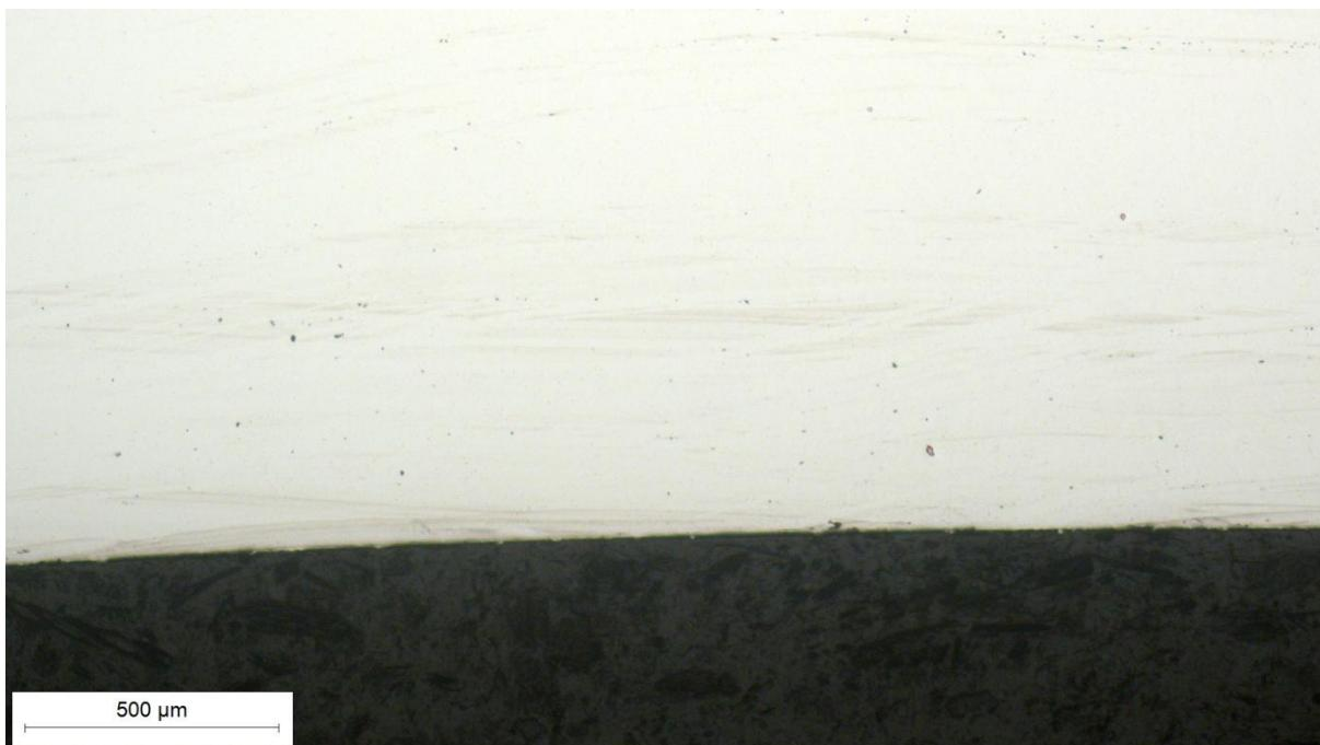
Slika 23. Unutarnji rub poprečnog presjeka stijenke matrice, snimljeno pri povećanju  $50\times$
