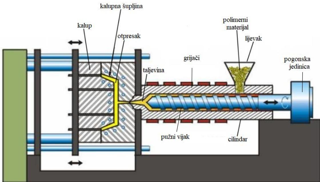
Slika 2. Jednostavniji prikaz sustava injekcijskog prešanja [6]
