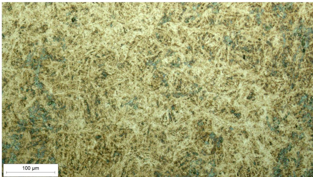
**Slika 30.** Mikrostruktura poprečnog presjeka stijenke matrice u sredini, snimljeno pri povećanju  $200\times$
