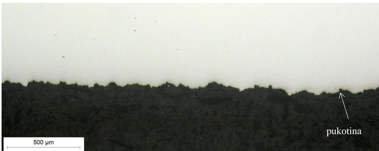
Slika 24. Uzdužni presjek ruba pukotine, snimljen pri povećanju  $50\times$
