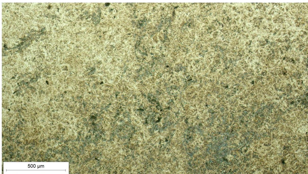
Slika 29. Mikrostruktura poprečnog presjeka stijenke matrice u sredini, snimljeno pri povećanju  $50\times$
