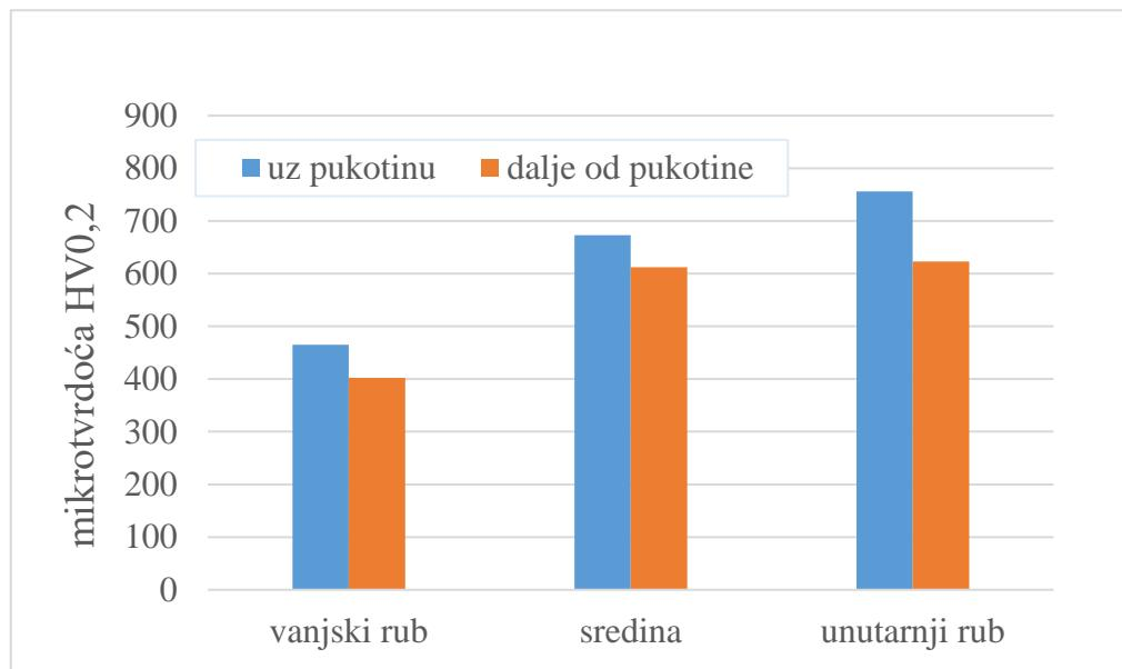
**Slika 41. Srednja vrijednost izmjerene mikrotvrdoće**
