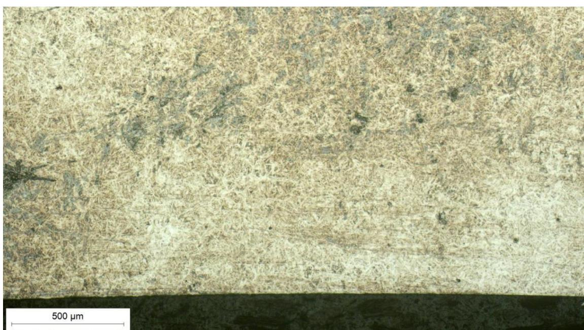
Slika 35. Mikrostruktura poprečnog presjeka stijenke matrice uz unutarnji rub, dalje od pukotine, snimljeno pri povećanju  $50\times$
