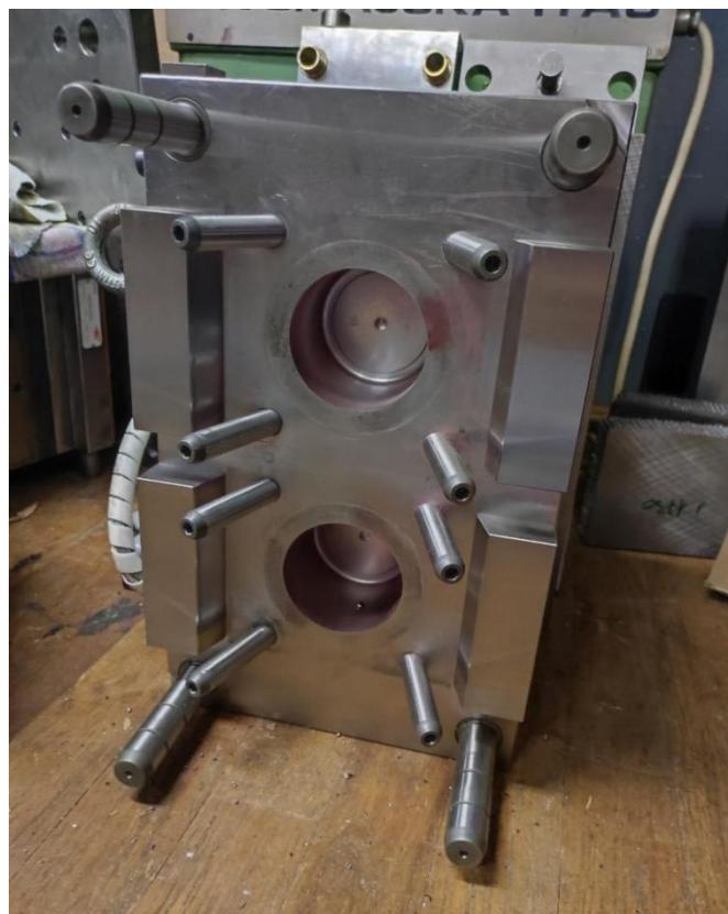
Slika 6. Nepomični dio kalupa za injekcijsko prešanje
