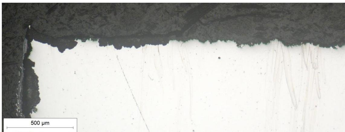
Slika 19. Poprečni presjek kroz stijenku kalupa uz rub pukotine, snimljen pri povećanju  $50\times$
