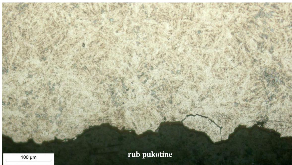
Slika 33. Mikrostruktura uzdužnog presjeka stijenke matrice uz rub pukotine, snimljeno pri povećanju  $200\times$
