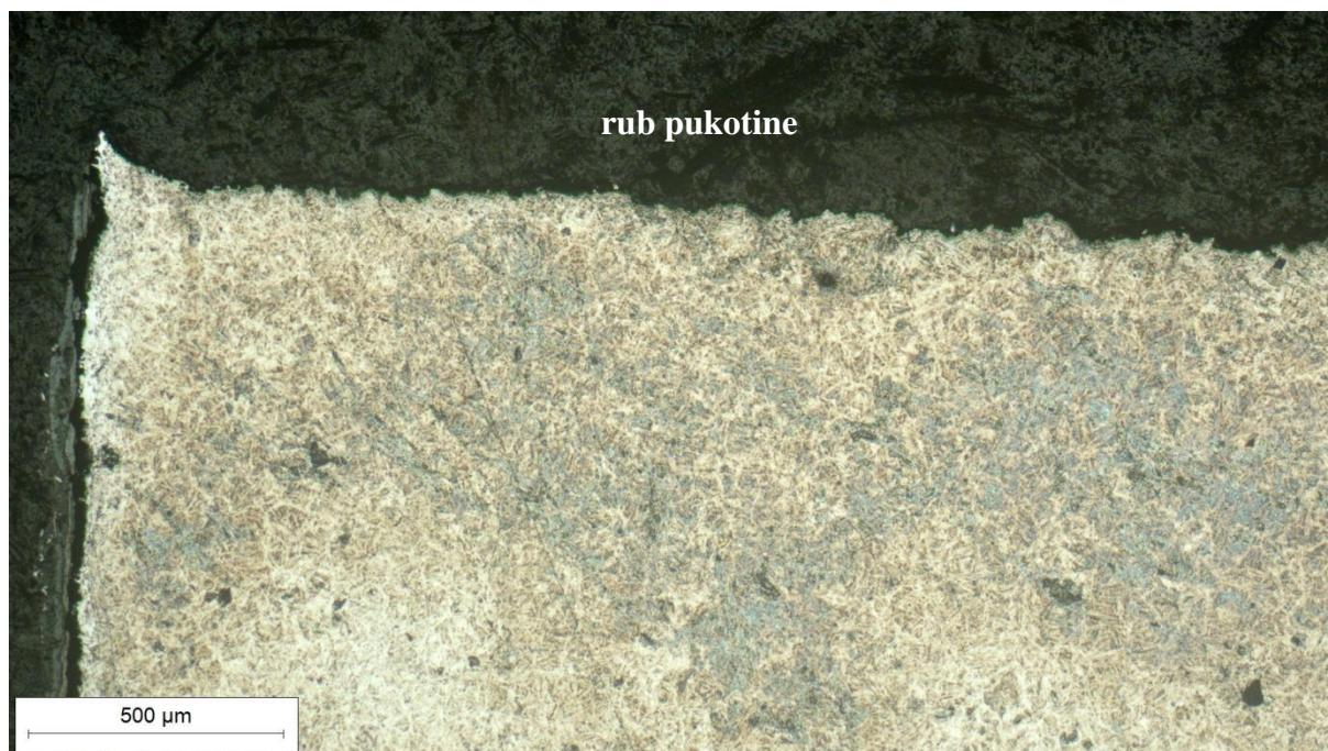
Slika 27. Mikrostruktura poprečnog presjeka stijenke matrice uz rub pukotine, snimljeno pri povećanju  $50\times$
