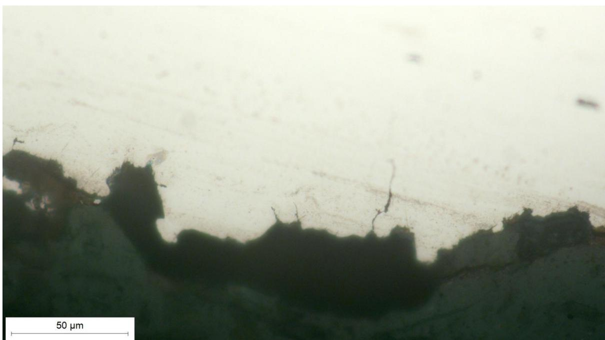
Slika 26. Uzdužni presjek ruba pukotine, snimljen pri povećanju 500×
