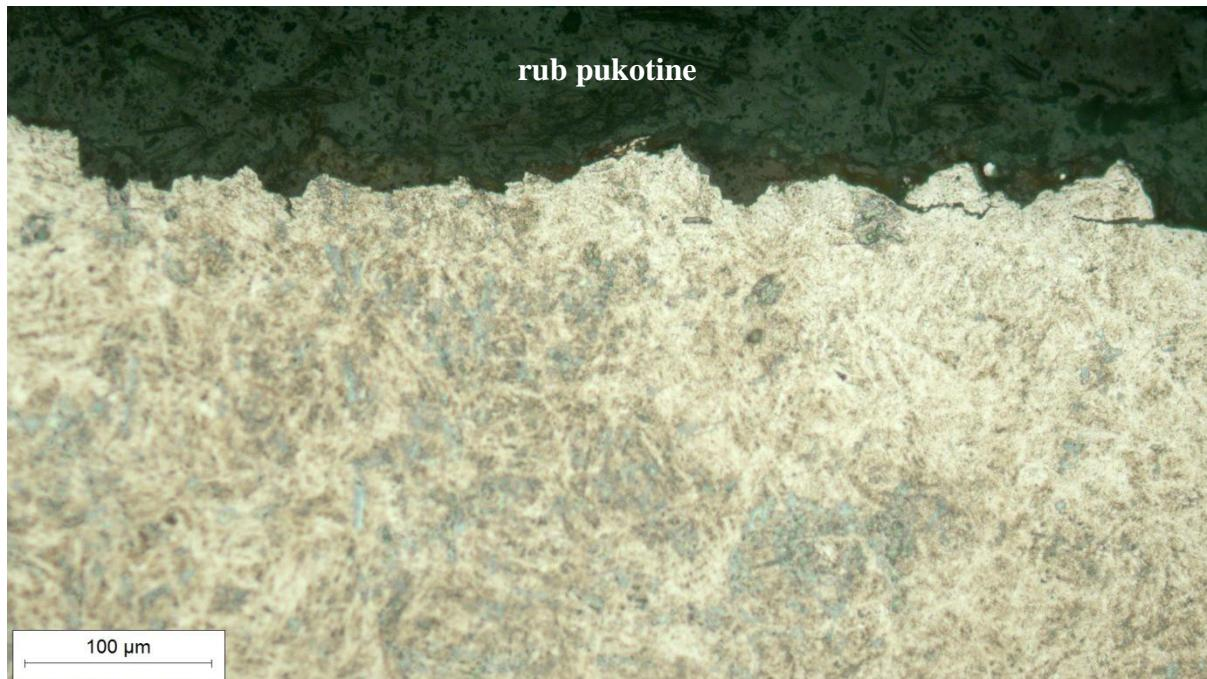
Slika 28. Mikrostruktura poprečnog presjeka stijenke matrice uz rub pukotine, snimljeno pri povećanju  $200\times$
