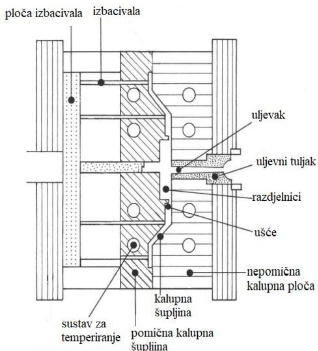
**Slika 4. Kalup za injekcijsko prešanje polimera [8]**
