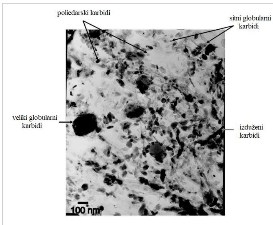
**Slika 40. Mogući oblici karbida u čeliku X37CrMoV5-1 [19]**
