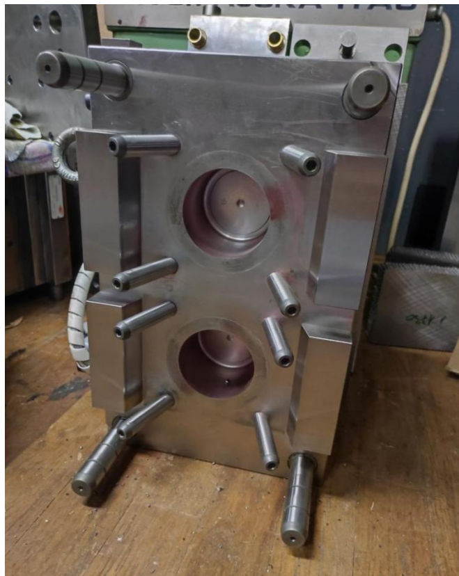
Slika 6. Nepomični dio kalupa za injekcijsko prešanje
