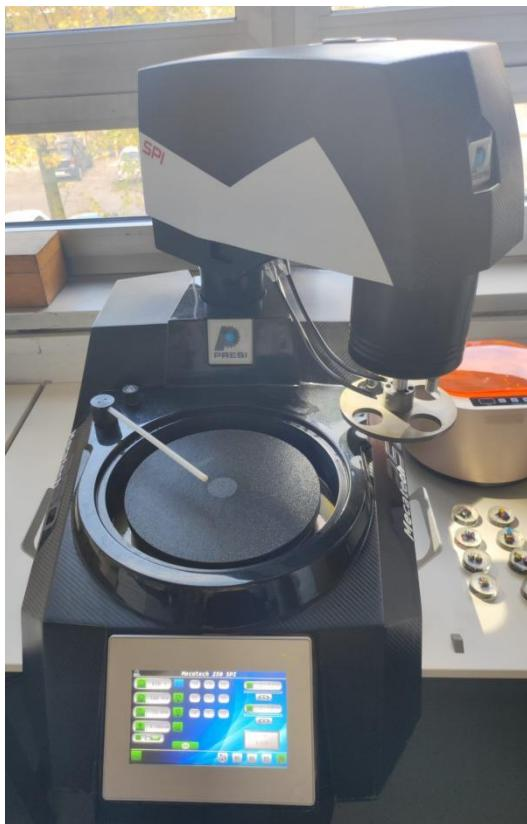
Slika 17. Uredaj za brušenje i poliranje Presi Mecatech 250 SPI
