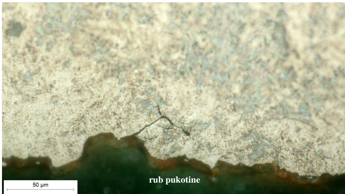
Slika 34. Mikrostruktura uzdužnog presjeka stijenke matrice uz rub pukotine, snimljeno pri povećanju  $500\times$
