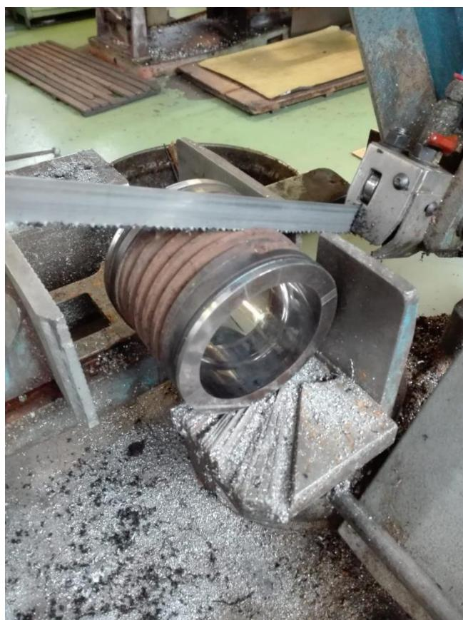
Slika 12. Izrezivanje uzorka na tračnoj pili
