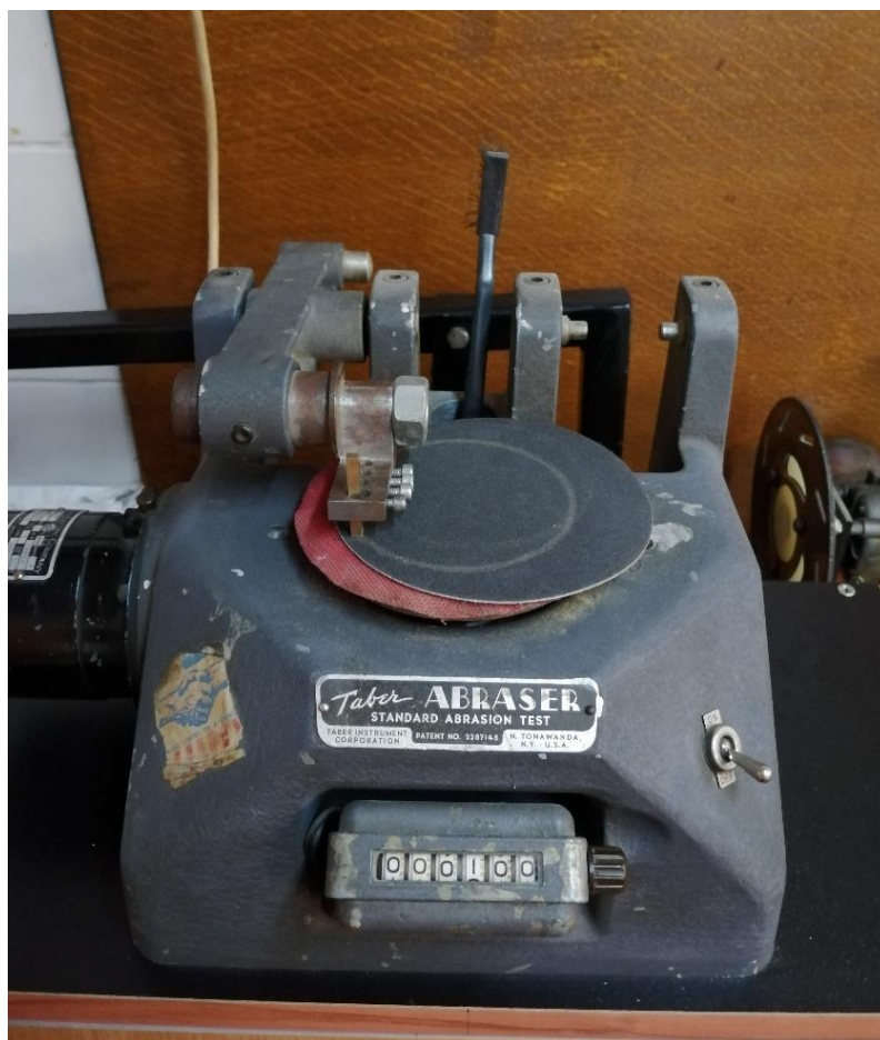
Slika 34. Ispitivanje otpornosti na abrazijsko trošenje na uređaju "Taber abrader"
