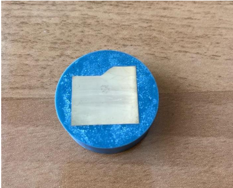
Slika 17. Metalografski uzorak nakon vađenja iz kalupa
