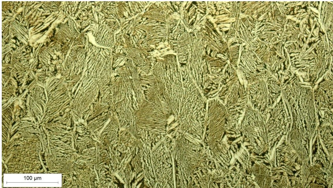
Slika 29. Prvi sloj navara u nagrizenom stanju, snimljeno pri povećanju 200×
