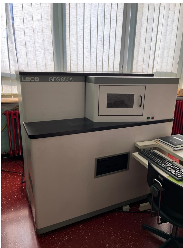
Slika 15. Uređaj za analizu kemijskog sastava GDS 850A LECO
