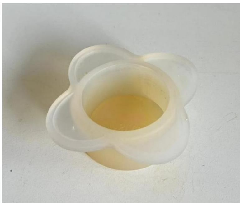
Slika 16. Kalup za zalijevanje uzorka
