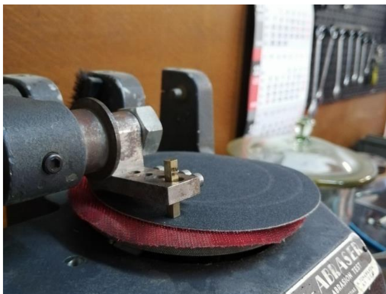
Slika 37. Postavljeni ispitni uzorak u čeljusti držača
