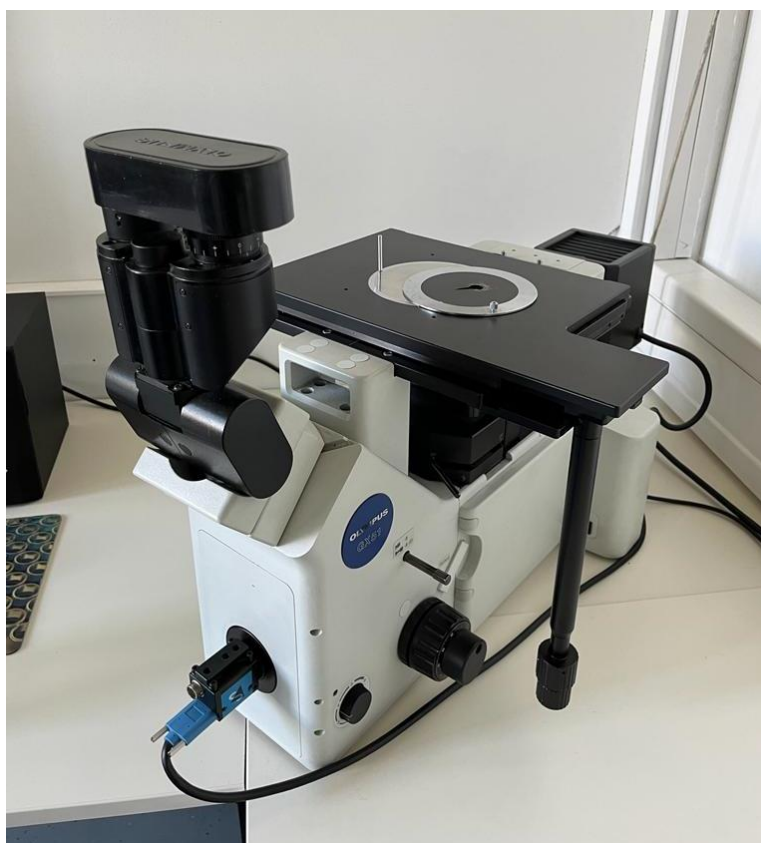
Slika 19. Svjetlosni mikroskop Olympus GX51
