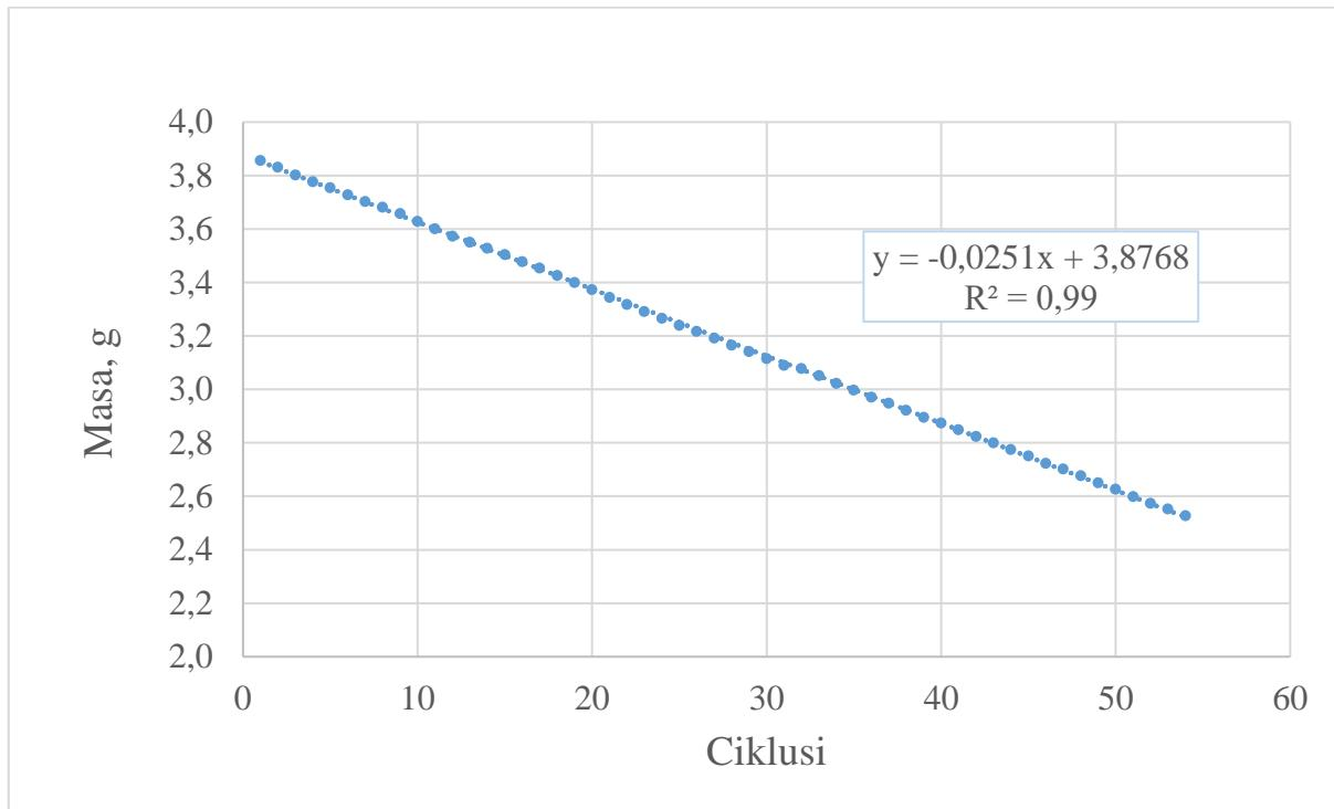
Slika 38. Smanjenje mase uzorka tijekom abrazijskog trošenja
