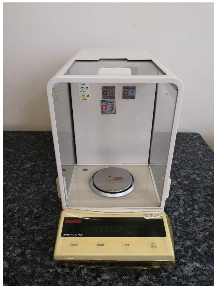
Slika 36. Mjerna vaga "Analytical Plus balance Ohaus"
