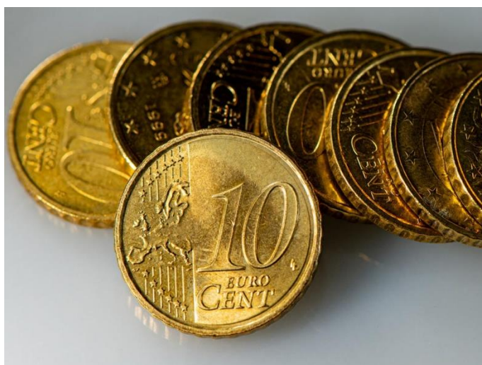
Slika 6. Eurocenti izrađeni od legure nordijsko zlato [16]
