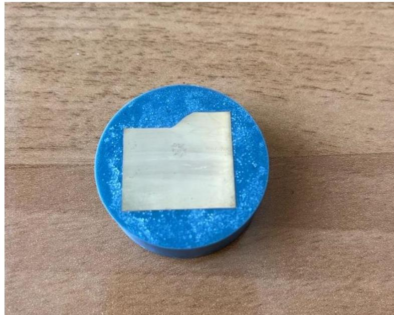
**Slika 17. Metalografski uzorak nakon vađenja iz kalupa**
