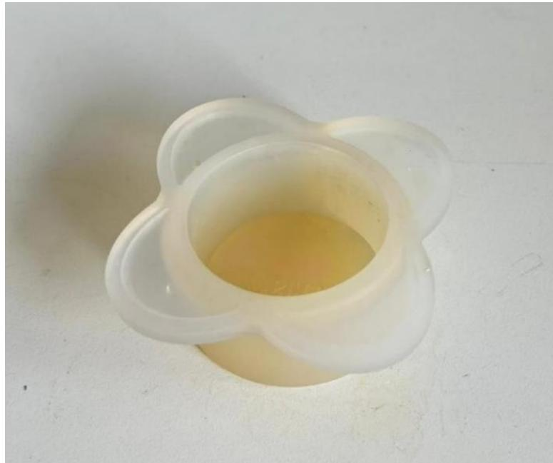
Slika 16. Kalup za zalijevanje uzorka
