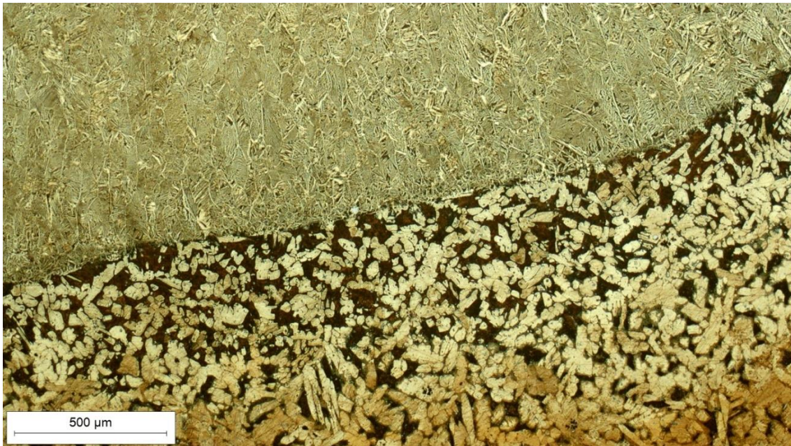
Slika 25. Zona utjecaja topline u nagrizenom stanju, snimljeno pri povećanju 50×
