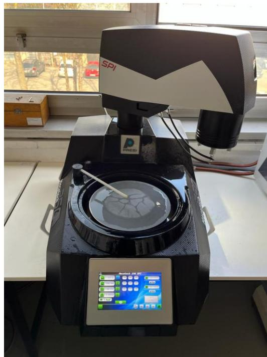
**Slika 18. Uredaj za brušenje i poliranje uzorka**
