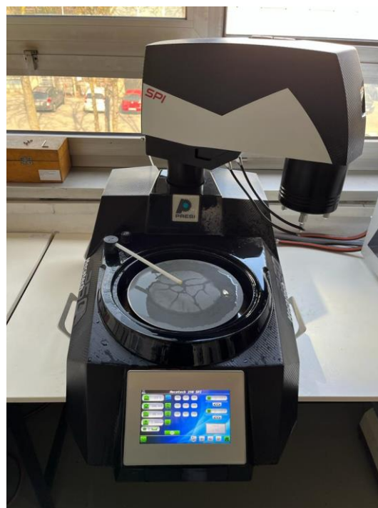
Slika 18. Uređaj za brušenje i poliranje uzorka
