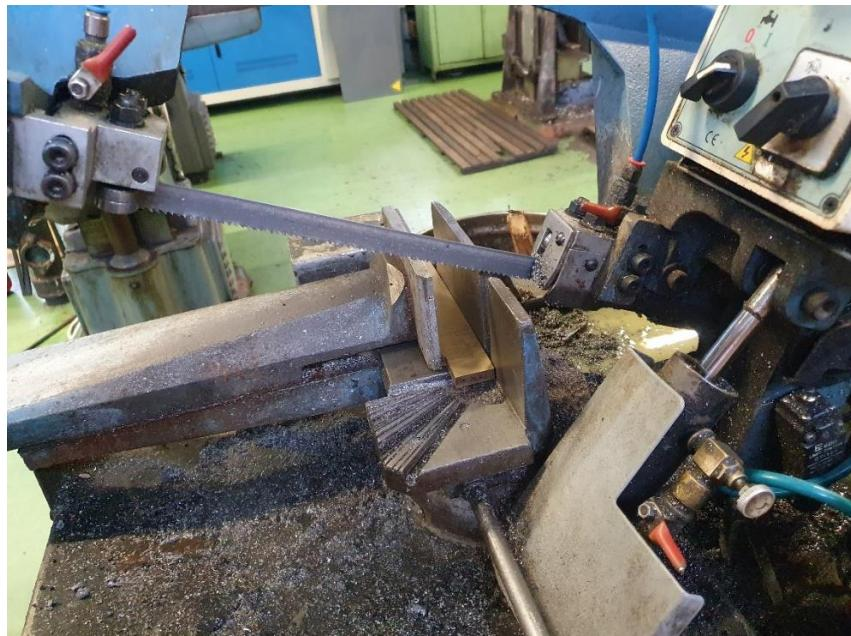
Slika 13. Rezanje uzorka na strojnoj pili
