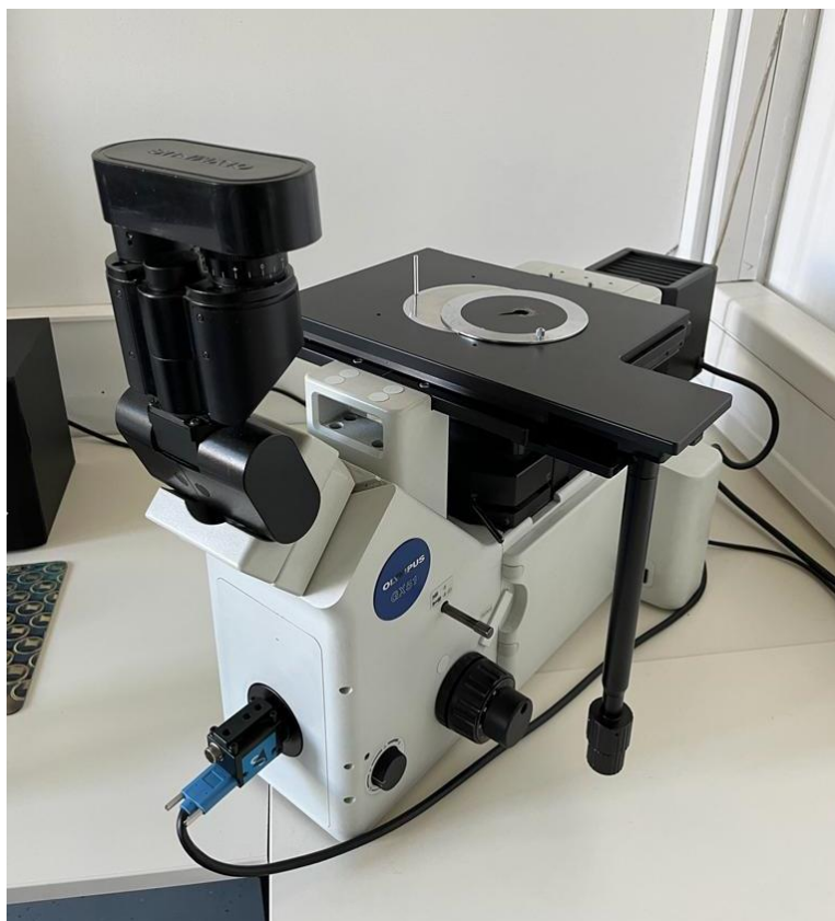
Slika 19. Svjetlosni mikroskop Olympus GX51
