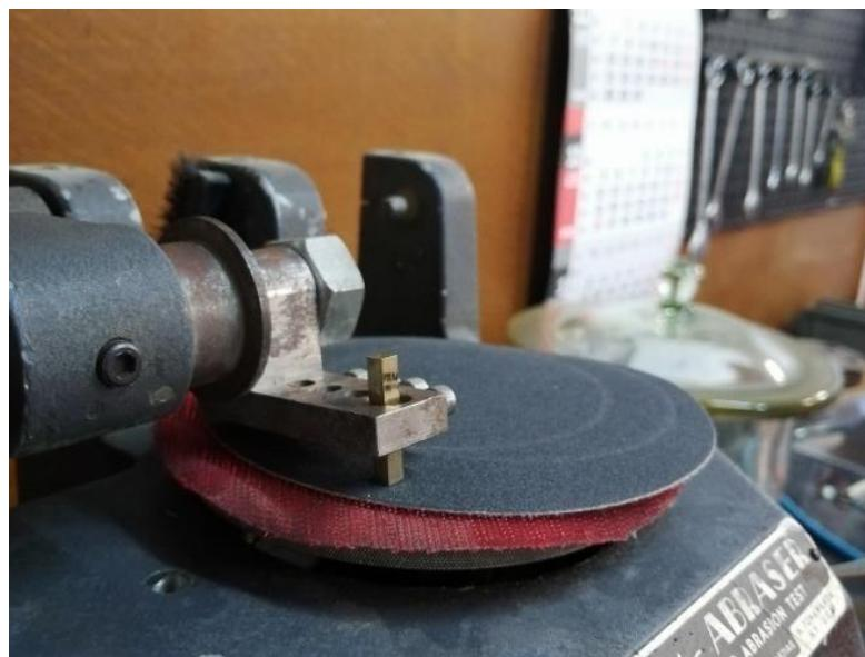
Slika 37. Postavljeni ispitni uzorak u čeljusti držača
