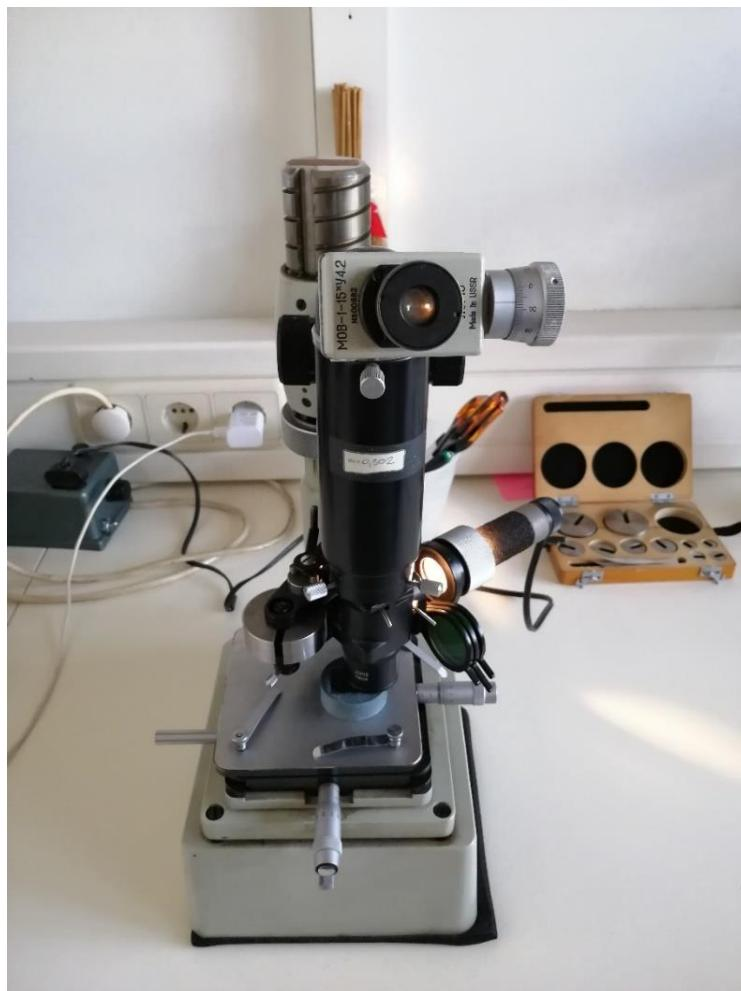
Slika 41. Mikrotvrdomjer PMT3
