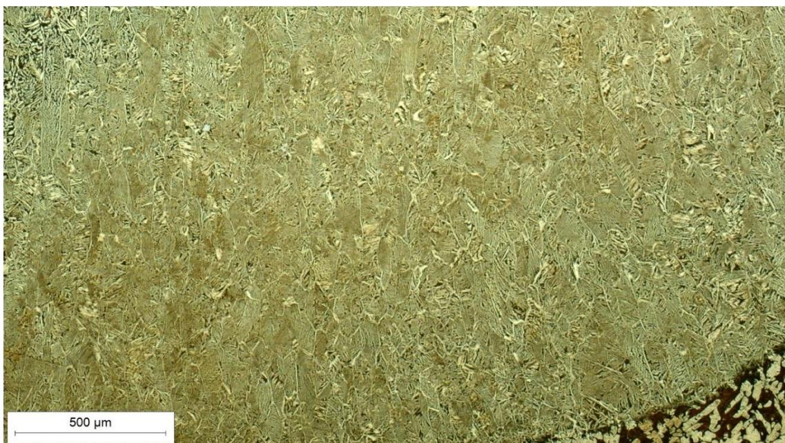
Slika 28. Prvi sloj navara u nagrizenom stanju, snimljeno pri povećanju  $50\times$
