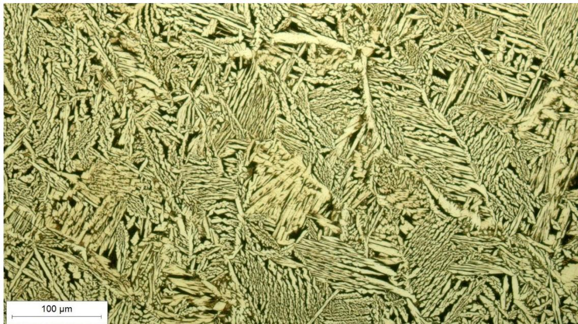
Slika 33. Treći sloj navara u nagrizenom stanju, snimljeno pri povećanju  $200\times$
