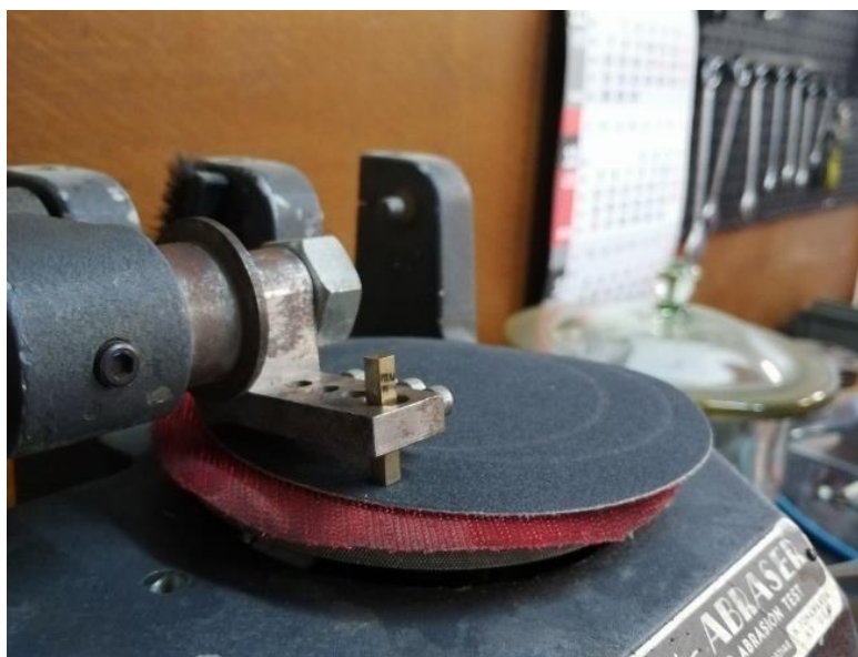
Slika 37. Postavljeni ispitni uzorak u čeljusti držača
