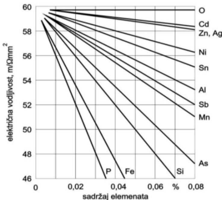
**Slika 3. Ovisnost električne vodljivosti bakra o udjelu primjesa [8]**
