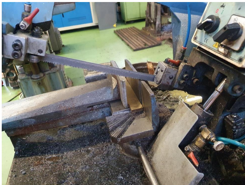
Slika 13. Rezanje uzoraka na strojnoj pili
