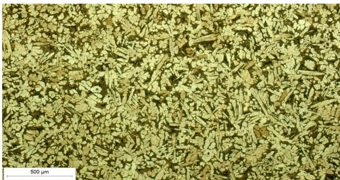
Slika 22. Osnovni materijal u nagrizenom stanju, snimljeno pri povećanju 50 $\times$
