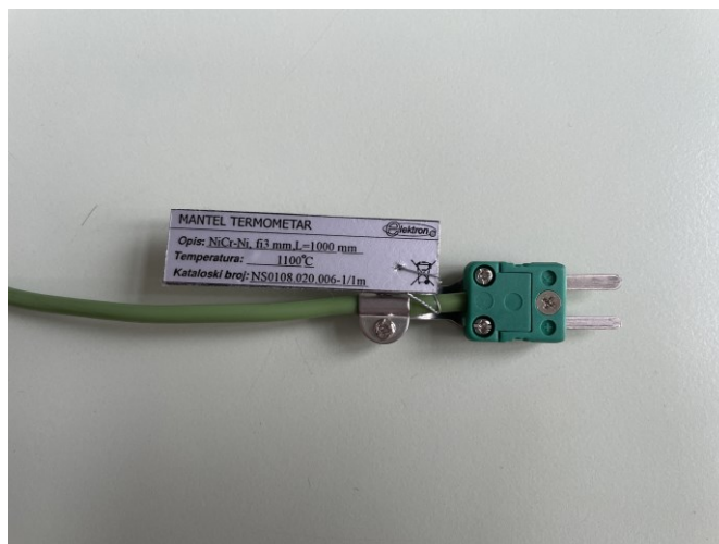
Slika 26. Termoelement tip K marke Mantel
