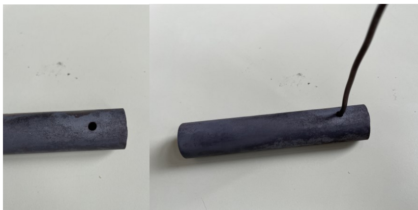
Slika 27. Položaj termoelementa u uzorku B
