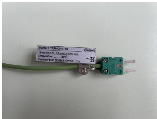
Slika 26. Termoelement tip K marke Mantel
