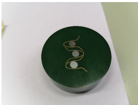
Slika 23. Prikaz metalografski pripremljenog uzorka s presjekom svrdla S0-1, S1-1 i S2-1
