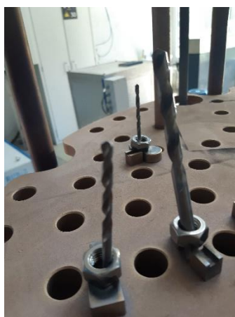
Slika 15. Postavljanje svrdla na napravu za prevlačenje u vakuumskoj komori PACVD
