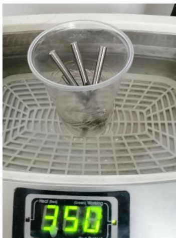
Slika 14. Odmašćivanje svrdla u ultrazvučnoj kupci
