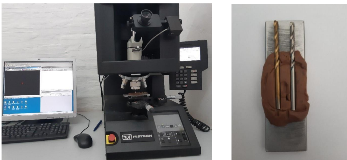
Slika 21. Ispitivanje mikrotvrdoće svrdla: a) tvrdomjer Wilson-Wolpert Tukon 2100B, b) priprema svrdla za ispitivanje tvrdoće
