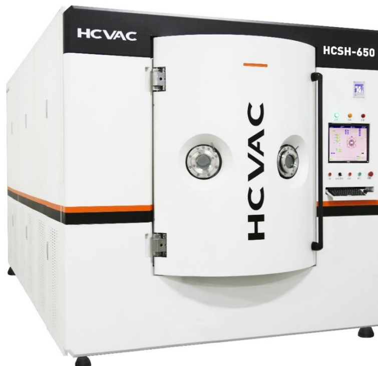
Slika 14. Vakuumska peć za PACVD postupak[29]
