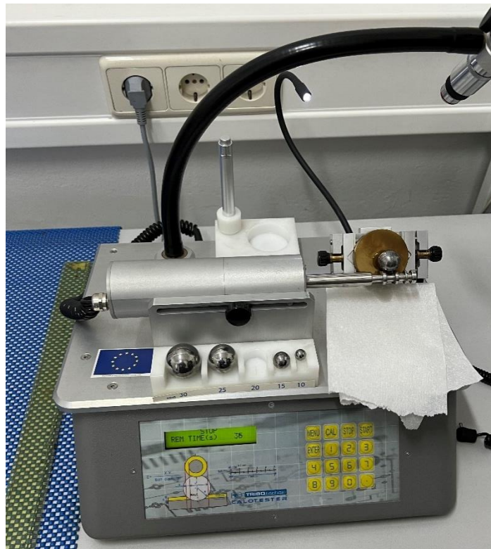
Slika 26. Calotester Tribotehnic na Fakultetu strojarstva i brodogradnje Zagreb
