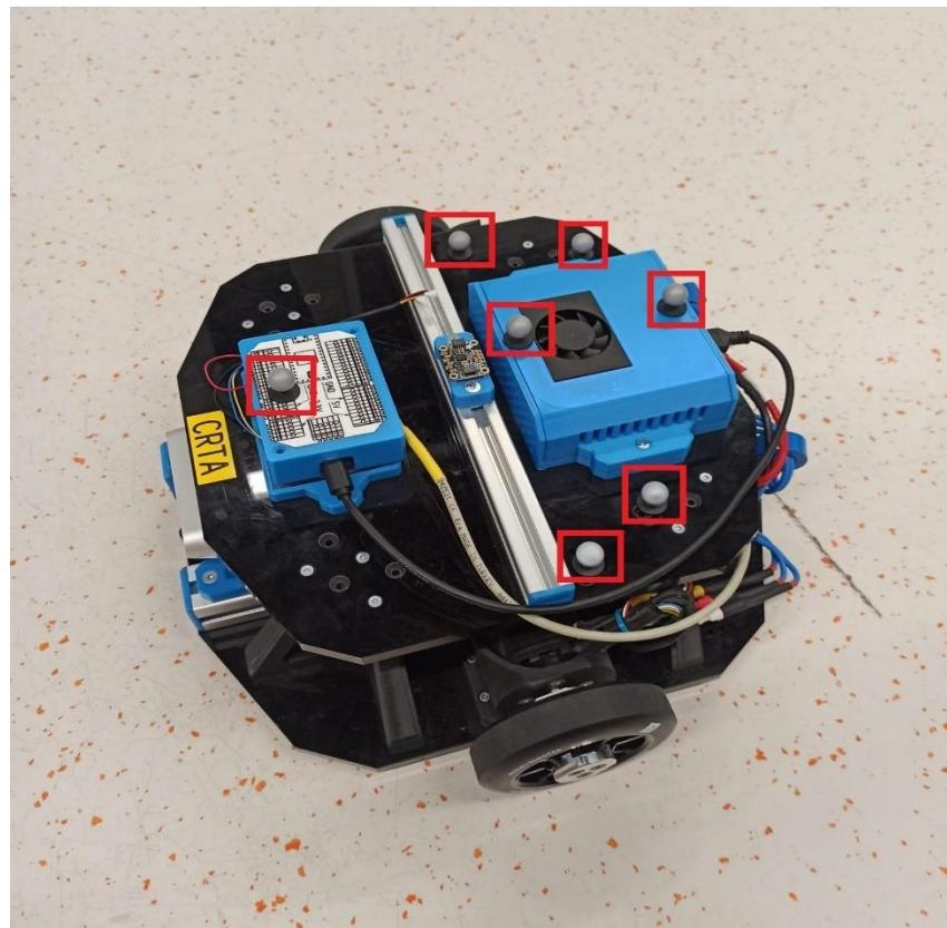
Slika 29. Postavljanje markera na mobilnog robota
