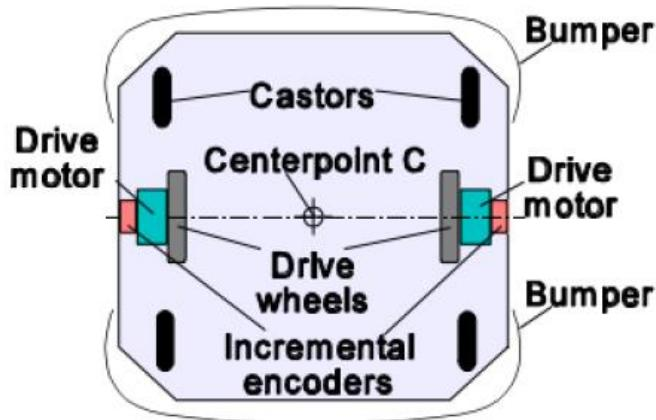
**Slika 34. Osnovni oblik mobilnog robota diferencijalne kinematike [12]**
