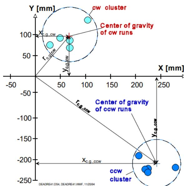
Slika 38. Prikaz rezultata nakon UMBMark eksperimenta [12]
