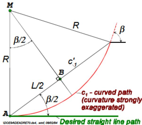
Slika 41. ABM trokut za izračun polumjera zakrivljenosti kretanje robota [12]
