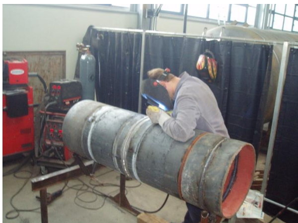
Slika 7.6 a) Zavarivanje STT postupkom- 12sati
