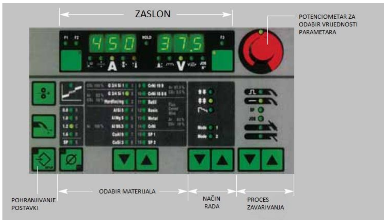
Slika 6.5 Zaslon upravljačke ploče MPS 4000 [13]
