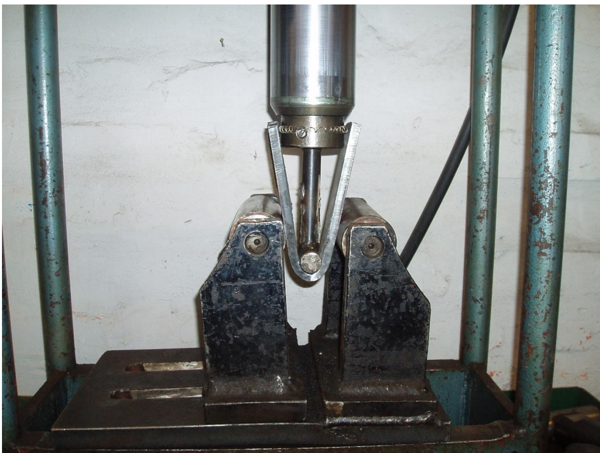
Slika 7.17 Ispitivanje savijanjem po HRN EN ISO 910
