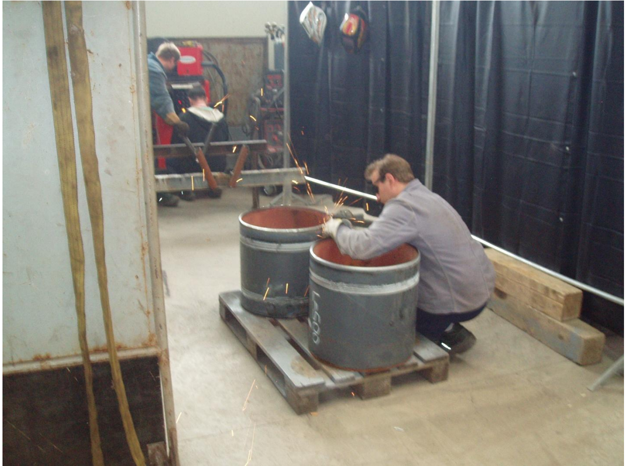
Slika 7.5 Priprema spoja brušenjem
