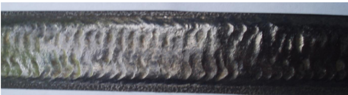
Slika 7.12 Prikaz završnog sloja zvara
