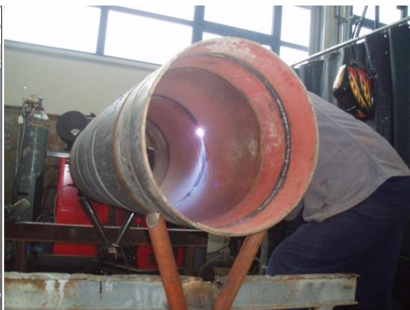
Slika 7.6 b) Zavarivanje STT postupkom- 3 sata
