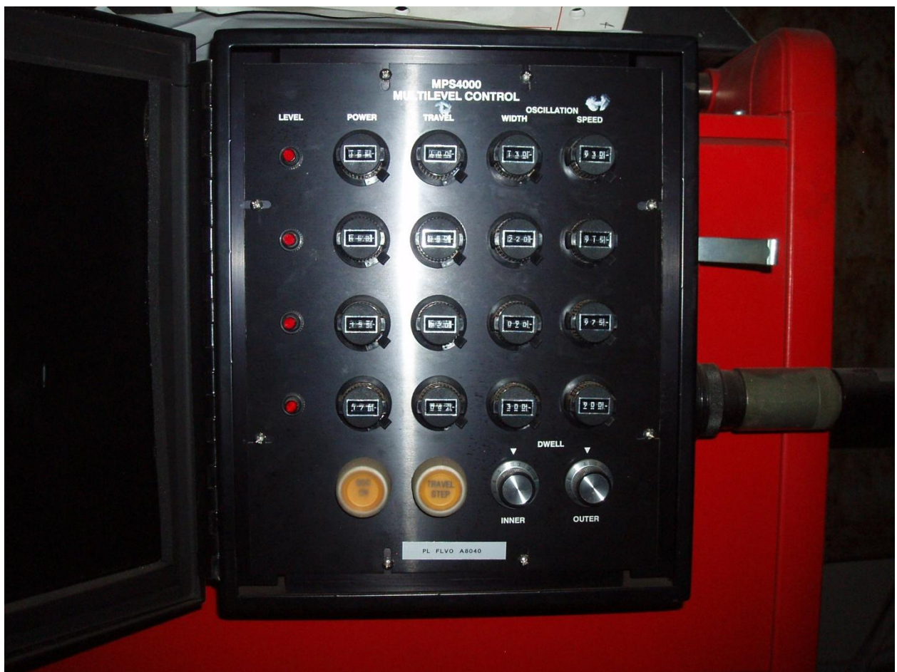
Slika 6.6 Višekanalni programator MPS 4000 MULTILEVEL CONTROL
