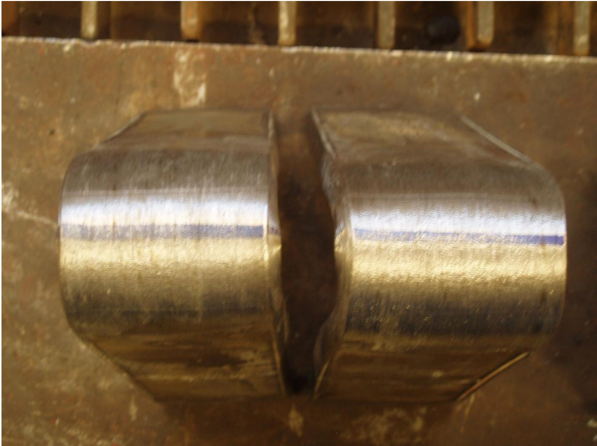
Slika 7.18 Epruveta zavarena STT postupkom zavarivanja nakon ispitivanja savijanjem
