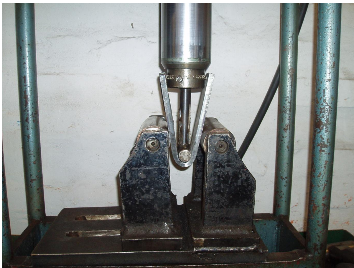
Slika 7.17 Ispitivanje savijanjem po HRN EN ISO 910
