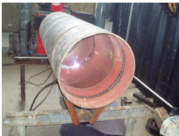
Slika 7.6 c) Zavarivanje STT postupkom- 6sati
