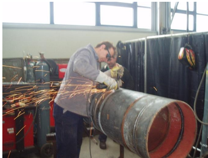
Slika 7.7b) Brušenje pri nastavljanju zavarenog spoja
