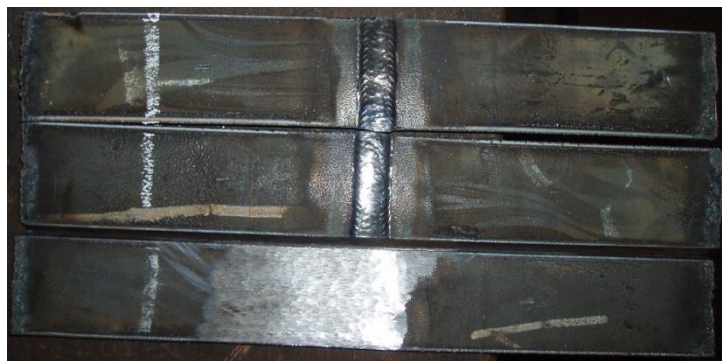
Slika 7.15 Epruvete za savijanje prije i nakon brušenja zavora
