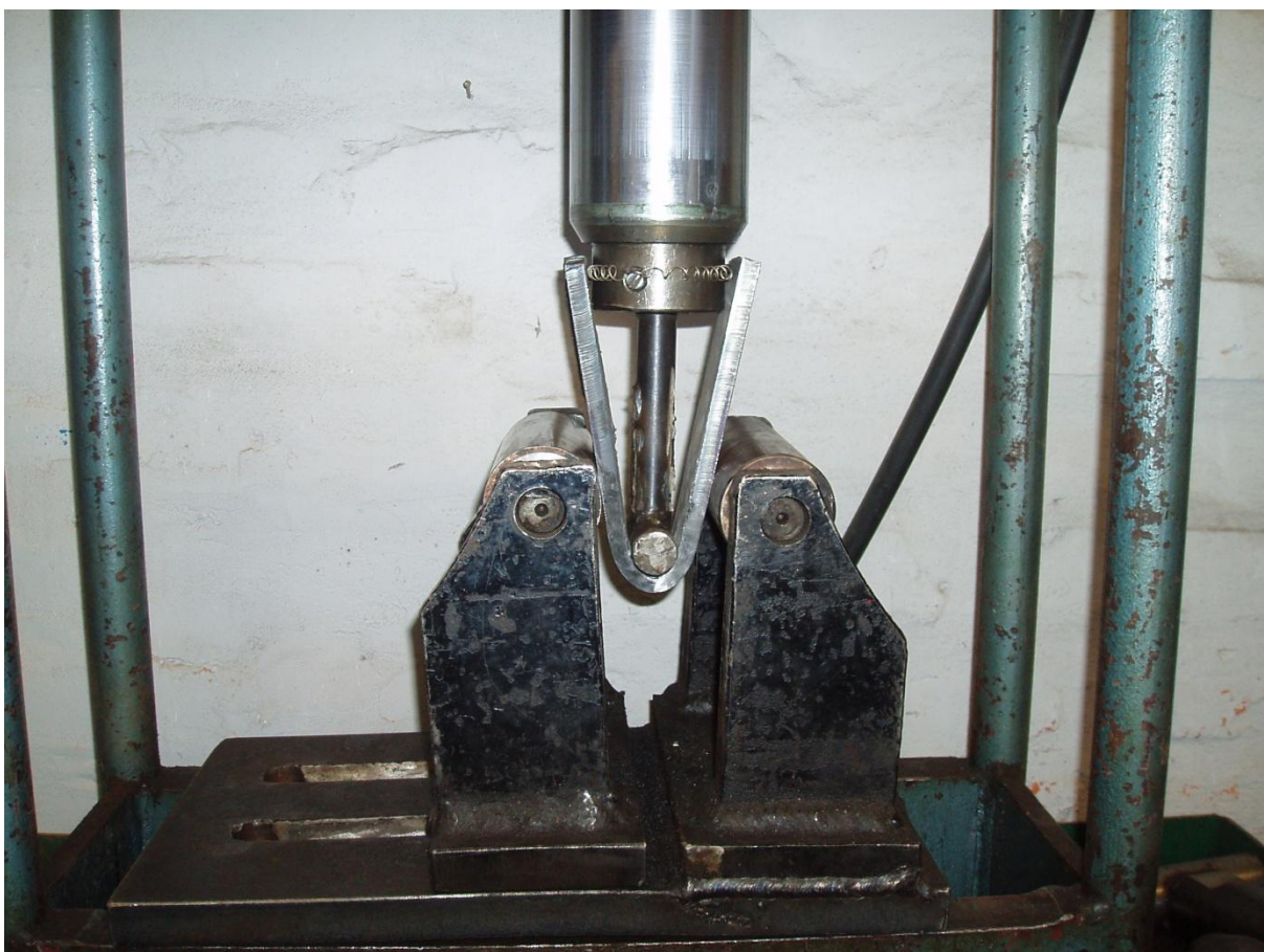
Slika 7.17 Ispitivanje savijanjem po HRN EN ISO 910
