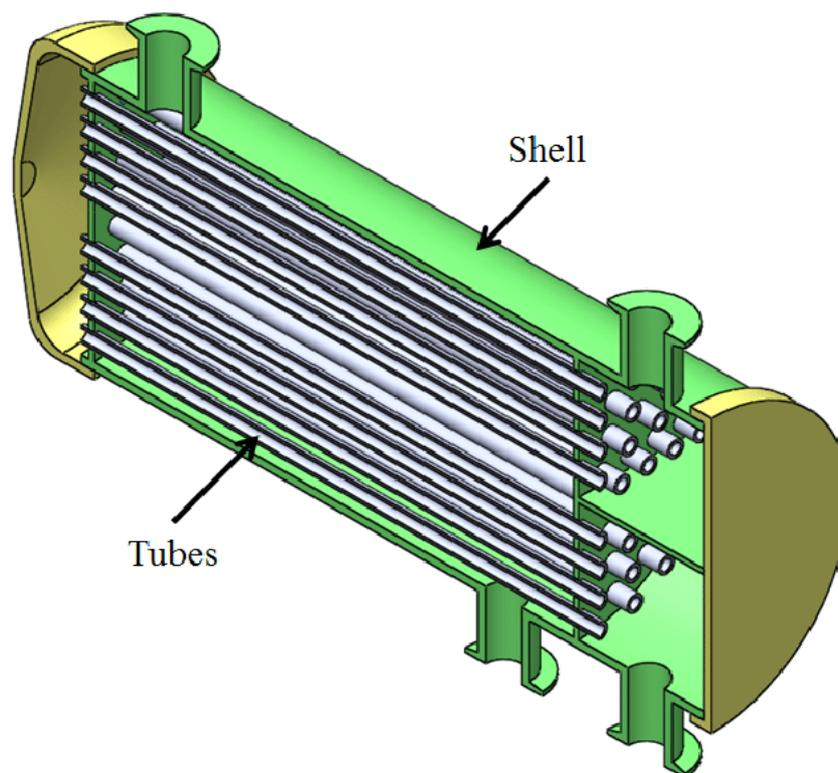
Slika 4. Shematski prikaz shell&tube izmjenjivača topline [18]
