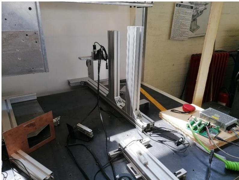
Slika 13. Montaža galvo glave na žarišnu duljinu leće
