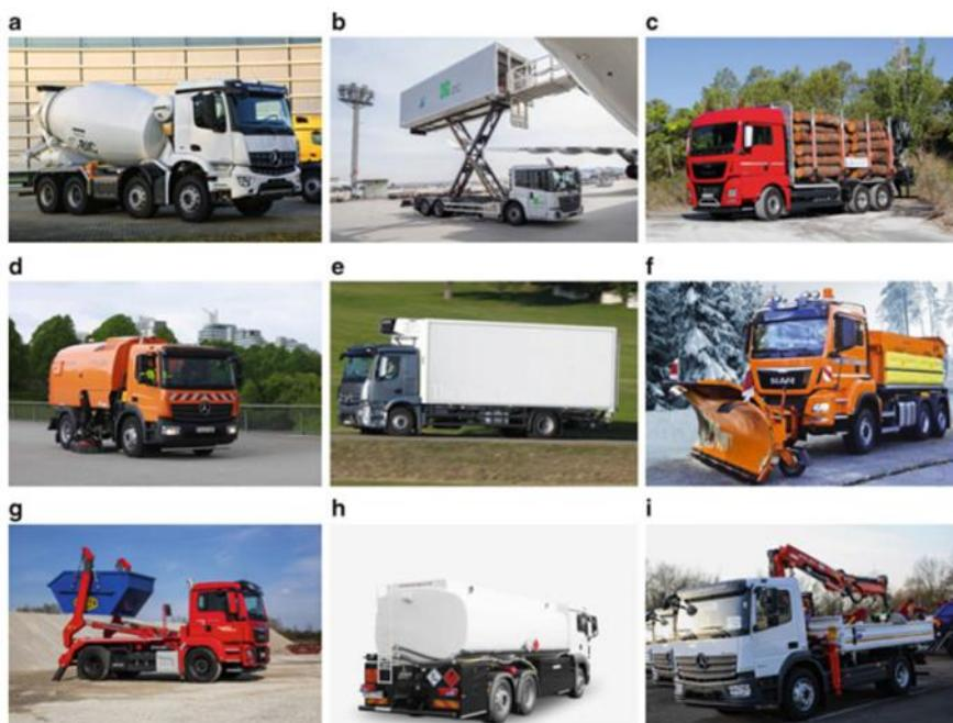
Slika 5. Primjeri različitih izvedbi nadogradnje vozila [7]
