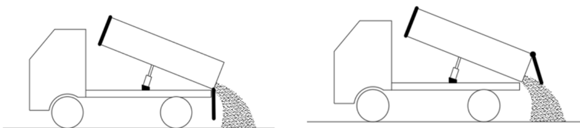
Slika 16. Ručno otvaranje sanduka prema dolje (lijeva slika) i prema gore (desna slika)
