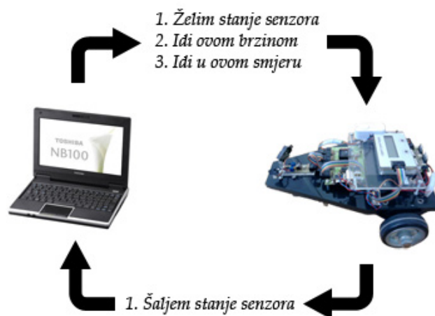
Slika 4.2: Razmjena paketa između serverske strane i mobilnog robota
