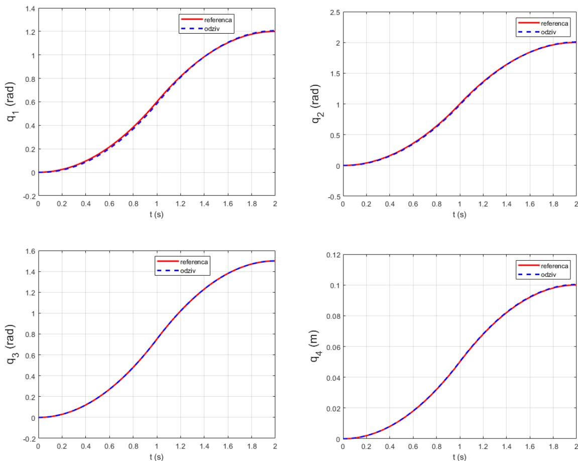
Slika 25. Odzvi pozicija robota s upravljanim koordinatama PD regulatorom na paraboličnu pobudu
