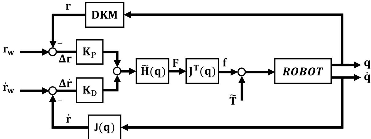
Slika 15. Vođenje robota u prostoru vanjskih koordinata po kriteriju virtualne sile, preuzeto sa [2]
