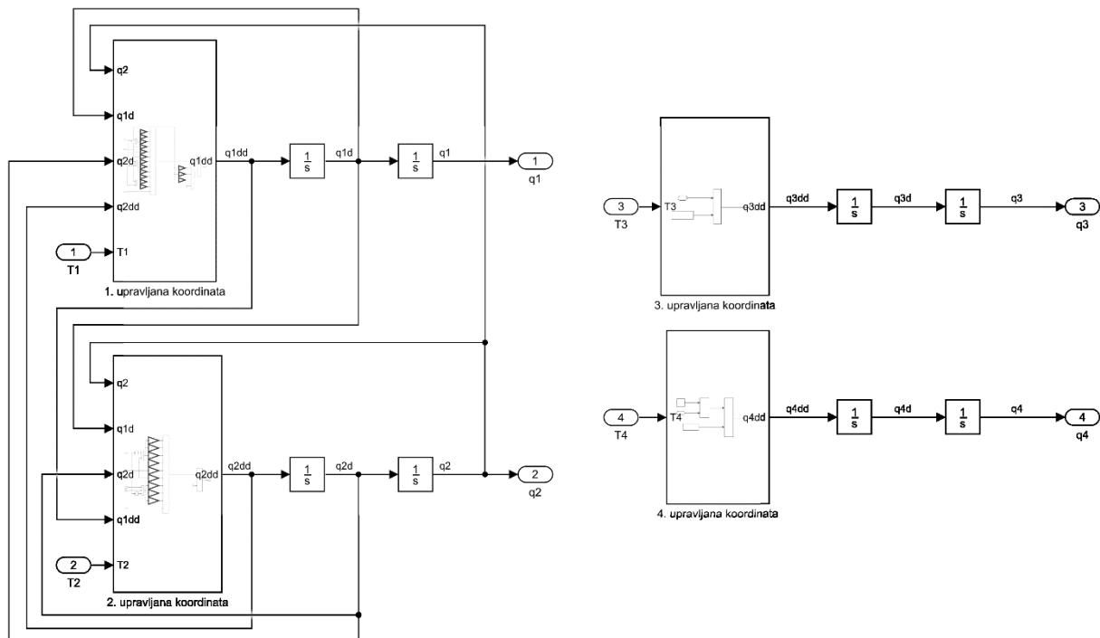
Slika 11. Simulacijski model SCARA robota
