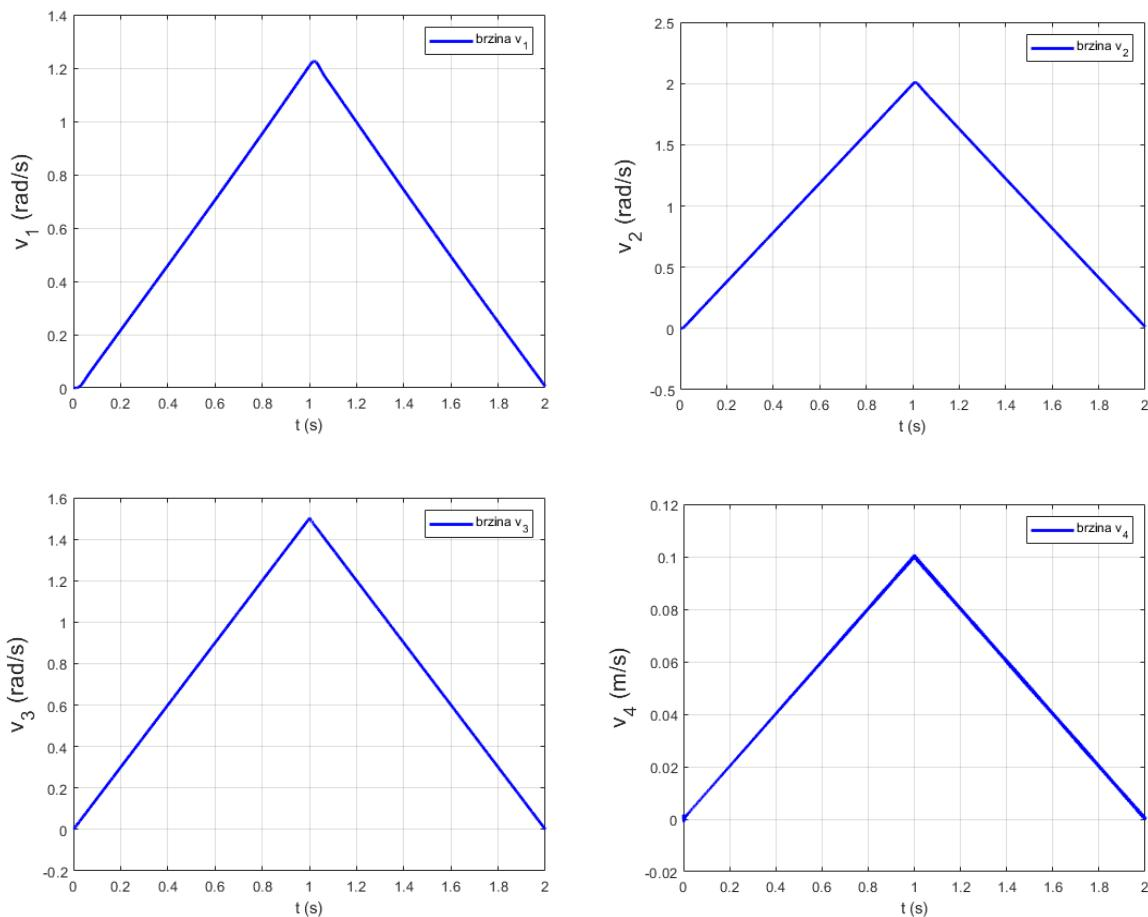
Slika 26. Odzivi brzina robota s upravljanim koordinatama PD regulatorom na paraboličnu pobudu
