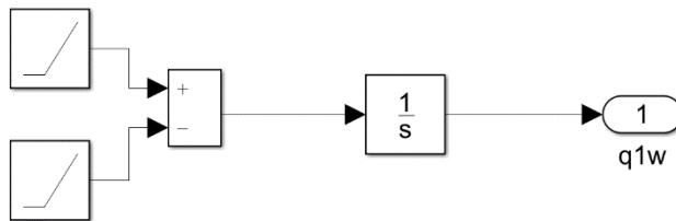
Slika 24. Parabolična referenca
