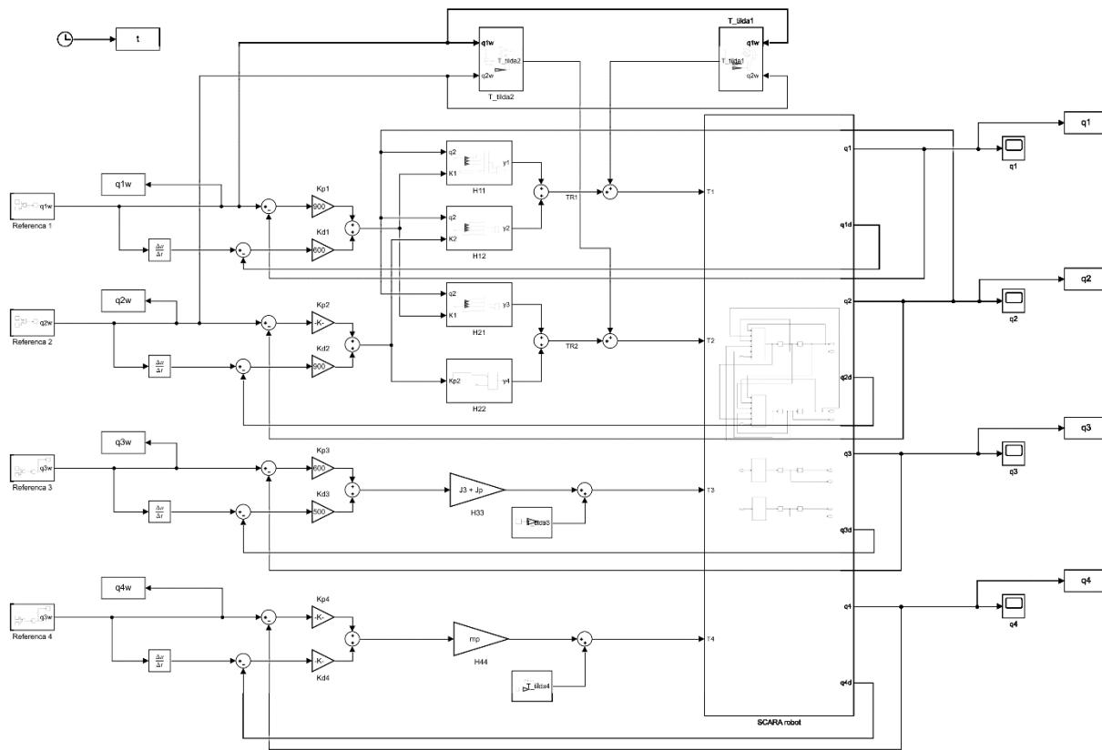
Slika 35. Konačni model za centralizirano upravljanje SCARA robota
