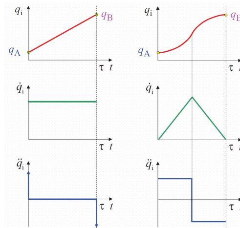
**Slika 19. Sinteza kinematike (lijevo-kvadratna; desno-trokutna), preuzeto sa [2]**
