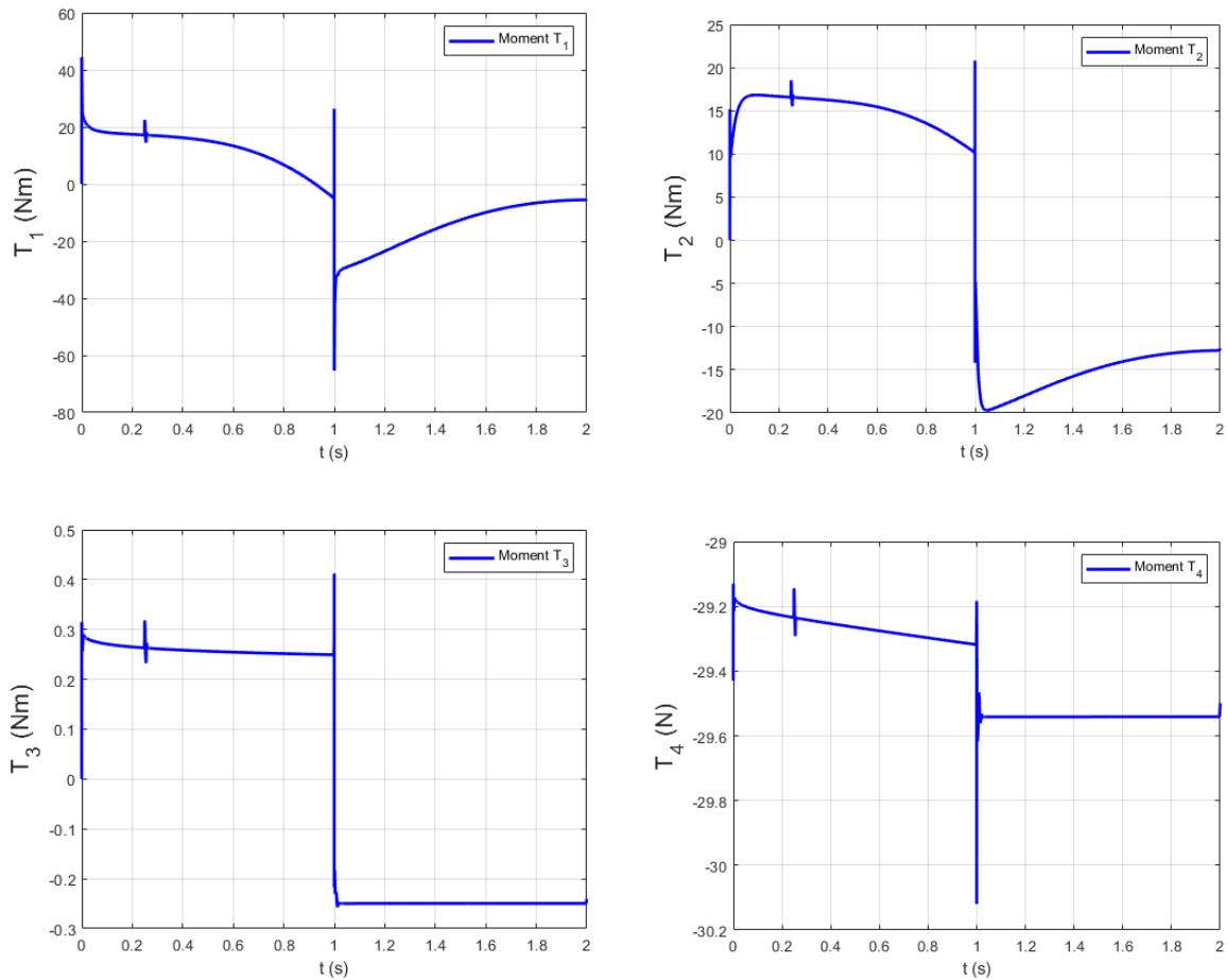
**Slika 42. Odzivi momenata robota s centraliziranim upravljanjem na paraboličnu pobudu**
