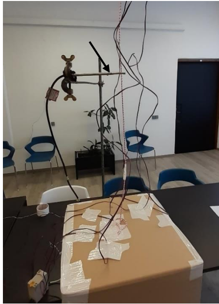
Slika 10. Lokacija anemometra iznad Modela 2
