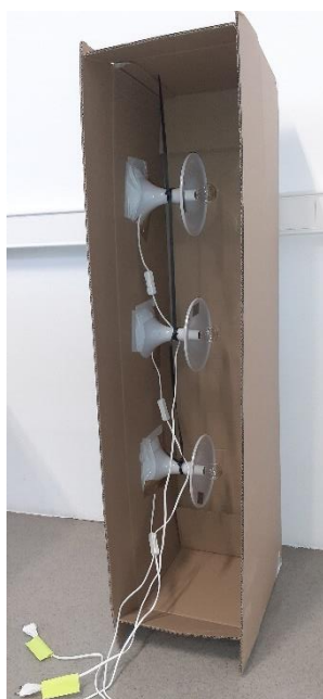
Slika 3. Model čovjeka sa žaruljama kao izvorom topline
