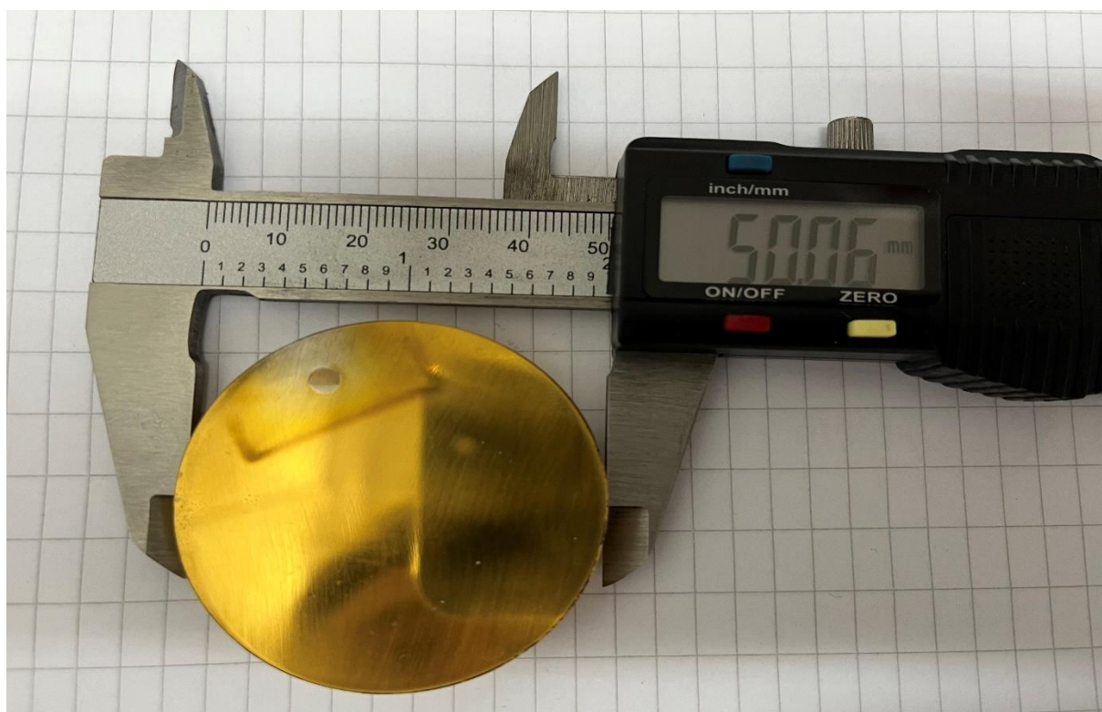
Slika 5. Titan nitridna prevlaka na čeliku EN DIN 100Cr6
