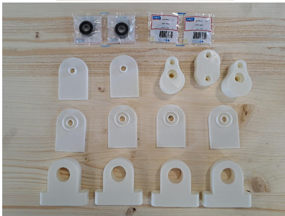
Slika 27. Izrada dijelova za koljenasto vratilo
