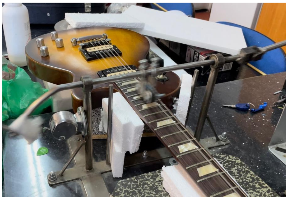
Slika 31. Gitara postavljena i učvršćena u napravi za ispitivanje trošenja
