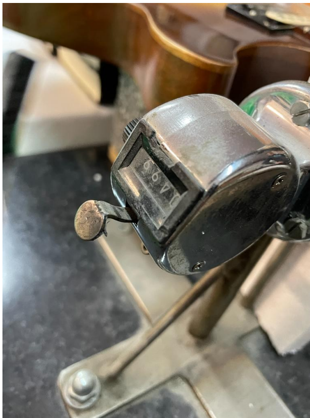
Slika 32. Brojačnik na napravi za ispitivanje trošenja
