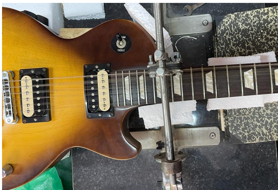
Slika 33. Prikaz krajnje točke pomaka naprave za ispitivanje trošenja iz tlocrta
