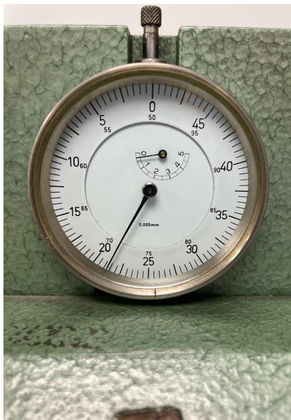
Slika 26. Mjerna skala na tvrdomjeru Zwick 3106
