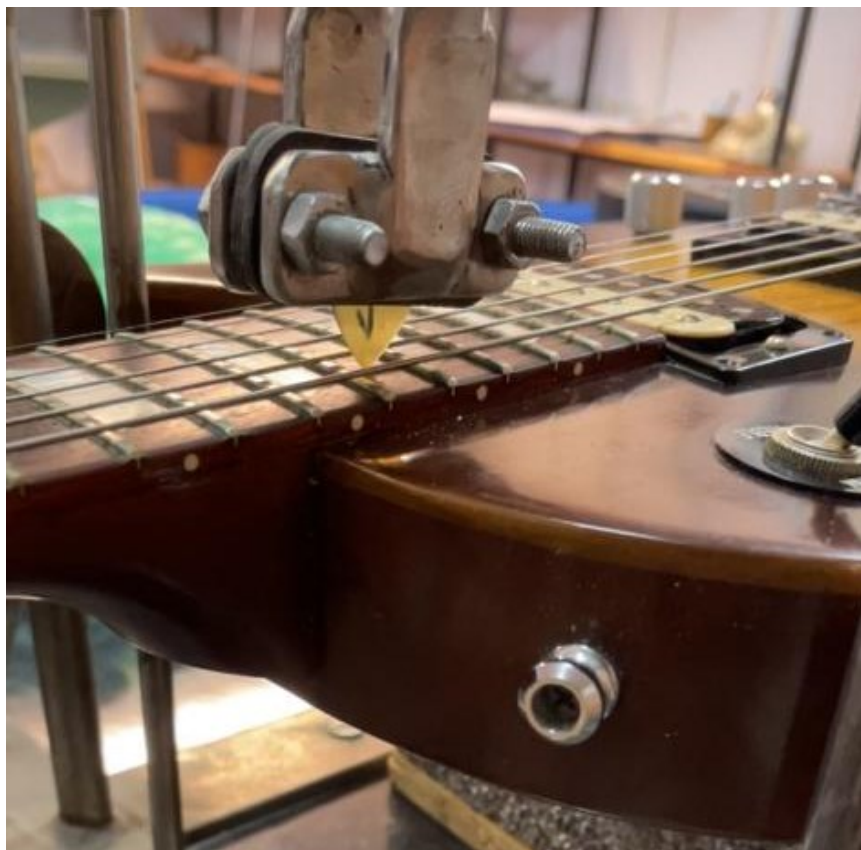
Slika 34. Trzalica postavljena u čeljusti
