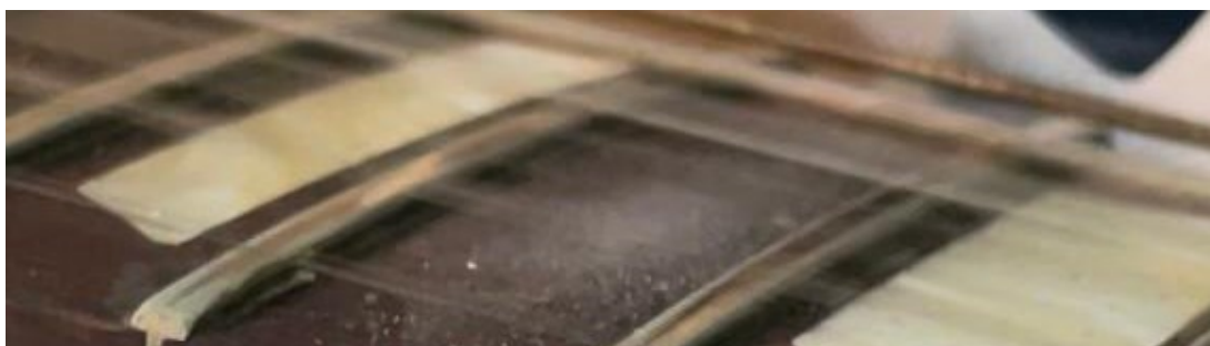
Slika 36. Čestice trošenja trzalice
