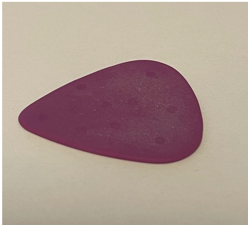
Slika 28. Uzorak trzalice nakon mjerenja tvrdoće
