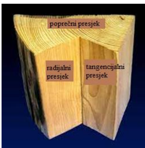
Slika 2.2. Položaj triju karakterističnih presjeka u deblu
