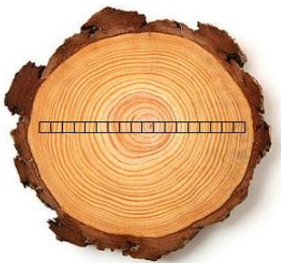
Slika 5.5. Položaj uzoraka na poprečnom presjeku
