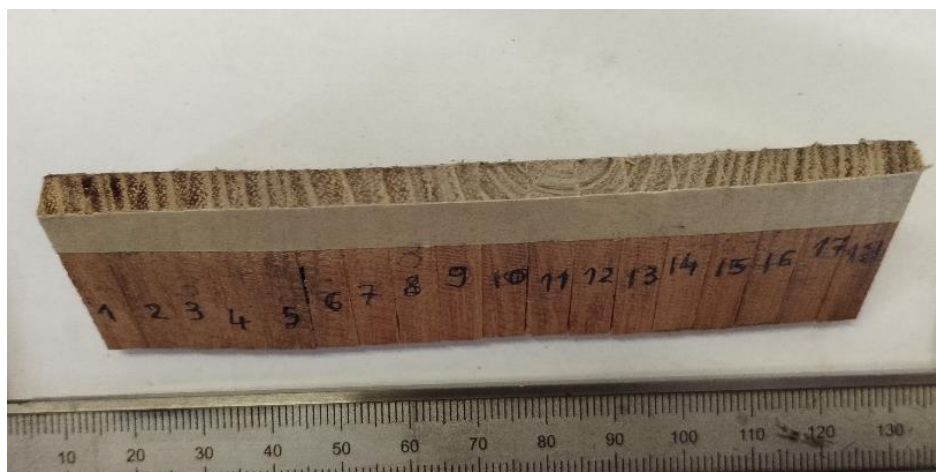
Slika 5.6. Uzorci za ispitivanje na abrazijsko trošenje
