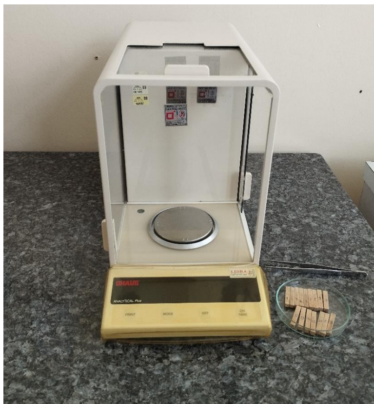
Slika 5.7. Analitička vaga Ohaus Analytic Plus
