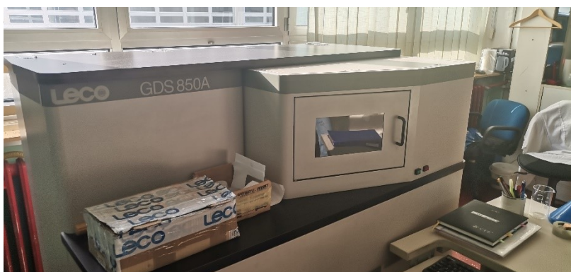
Slika 12. LECO Spectrometer 850 GDS izvana
