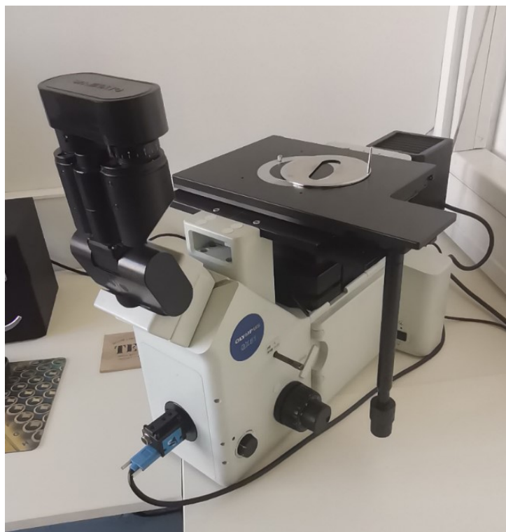
Slika 24. Optički invertni mikroskop Olympus GX51
