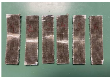
Slika 17. Ispitni uzorci nakon ispitivanja savojne čvrstoće i modula elastičnosti
