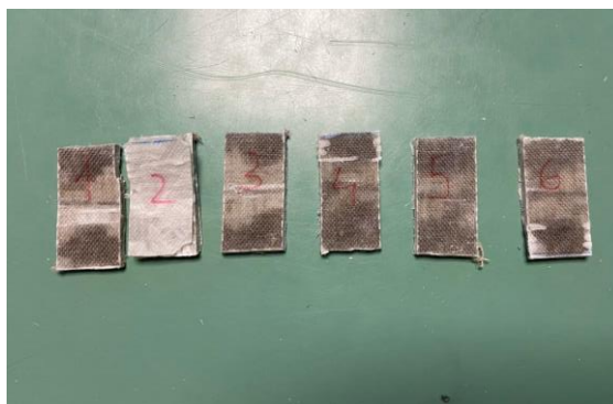
Slika 15. Ispitni uzorci nakon ispitivanja prividne međuslojne smične čvrstoće
