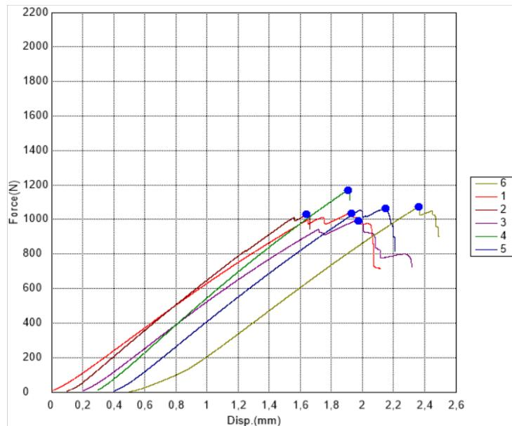
Slika 15. Dijagram sila – progib dobiven međuslojnim ispitivanjem za kompozit epoksid / staklo
