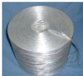
**Slika 8.Strukovi staklenog vlakna**
