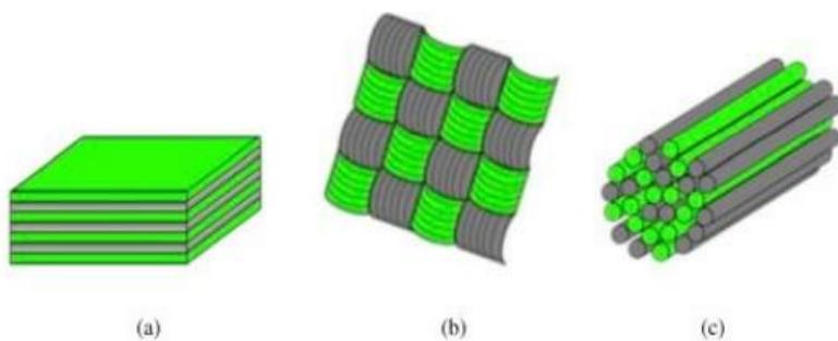
**Slika 9. Najčešći načini slaganja vlakna kod hibridnih kompozita [17]**
