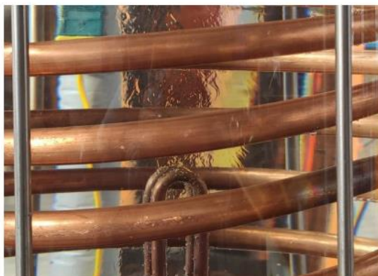
Slika 15. Slobodna konvekcija u spremniku
