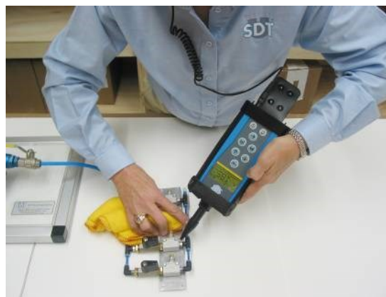
Slika 2. Zaštita od drugog izvora pomoću krpe [2]
