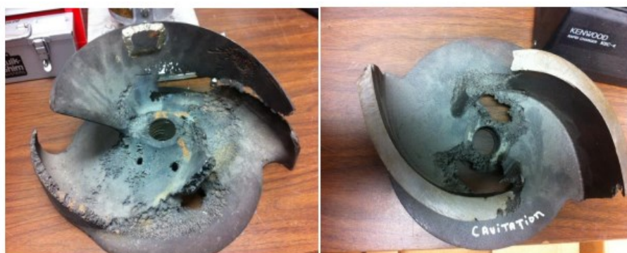
Slika 15. Prikaz oštećenih impelera pumpe [2]
