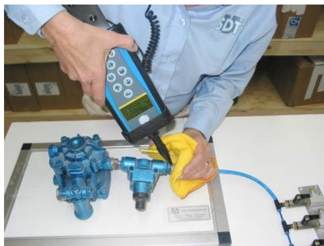
Slika 4. Prekrivanje propuštanja krpom [2]
