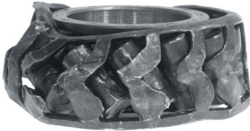
Slika 12. Primjer loše podmazanog ležaja i krajnja posljedica [7]
