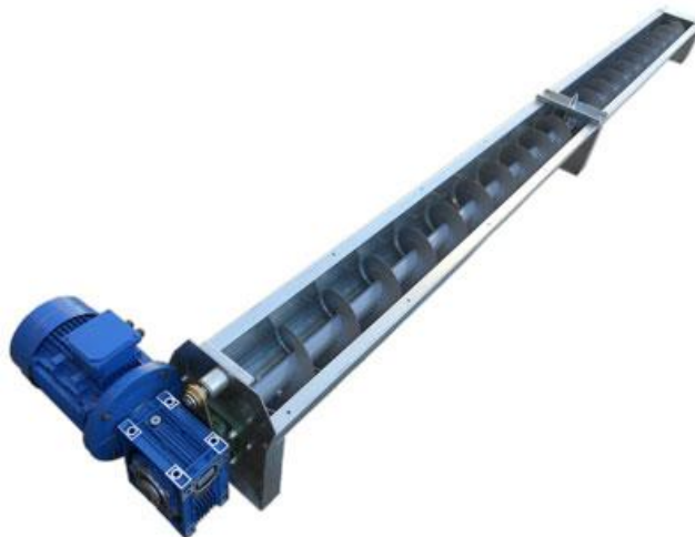
Slika 16. Horizontalni pužni transporter [12]
