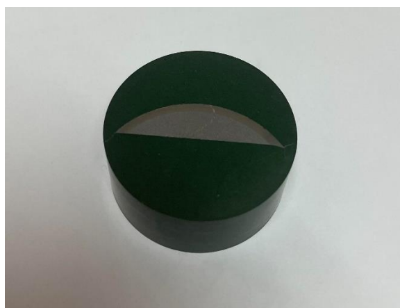
Slika 38. Odrezani uzorak osovine
