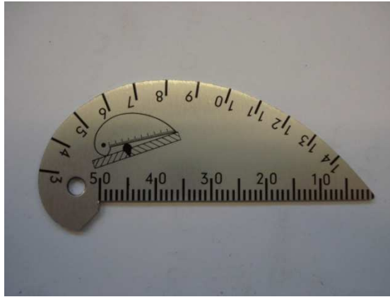
Slika 3. Jednostavno mjerilo za zavarene spojeve
