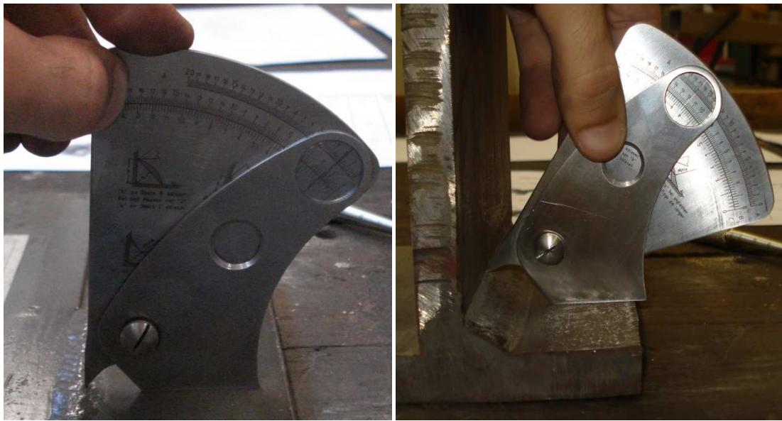
**Slika 11. Mjerilo s tri skale- pravilno korištenje**
