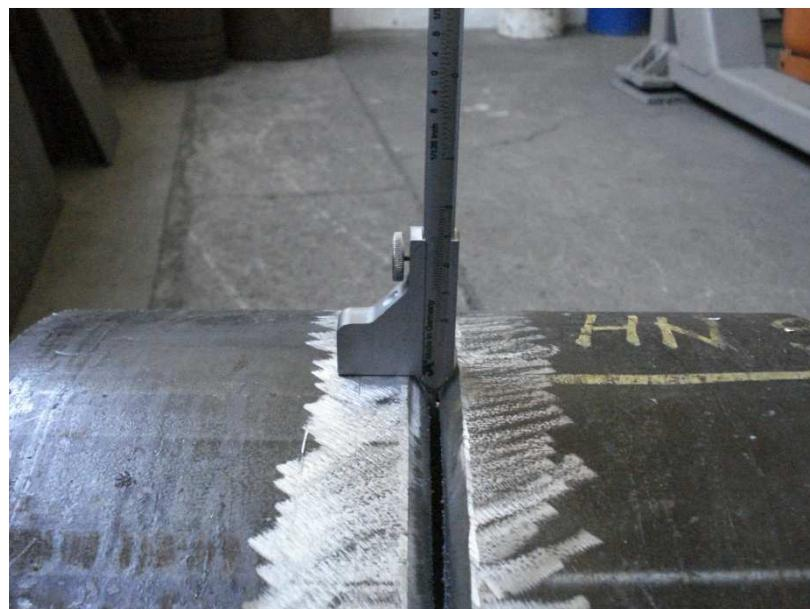
Slika 14. Mjerilo za mjerjenje posmknutosti
