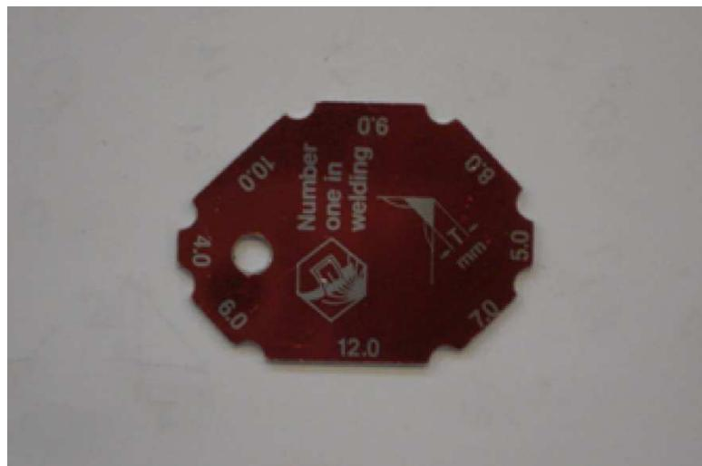
**Slika 6. Mjerilo za provjeru debljine kutnog zavarenog spoja**
