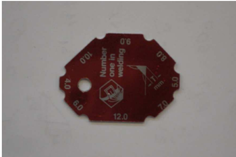
Slika 6. Mjerilo za provjeru debljine kutnog zavarenog spoja
