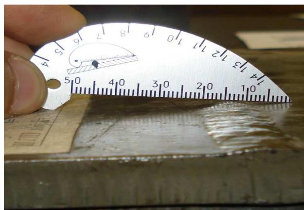
Slika 4. Jednostavno mjerilo za zavarene spojeve- pravilno postavljanje na sučevni zavareni spoj
