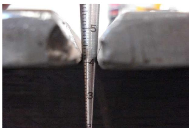
**Slika 13. Mjerilo za mjerjenje razmaka- pravilno postupanje**
