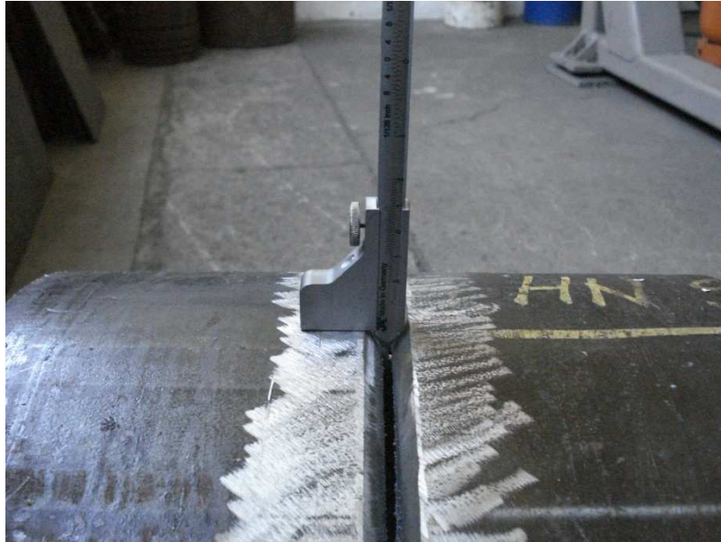
Slika 14. Mjerilo za mjerenje posmaknutosti
