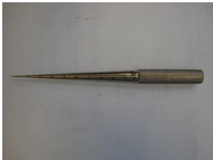
**Slika 12. Mjerilo za mjerjenje razmaka**
