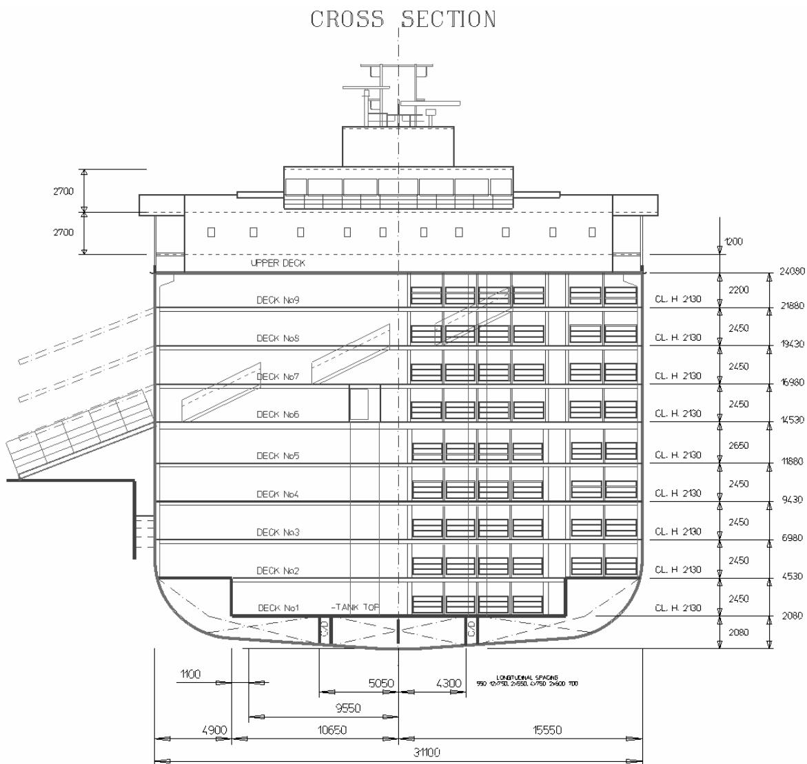
Slika 4. Poprečni presjek gradnje 428 s rasporedom paluba
