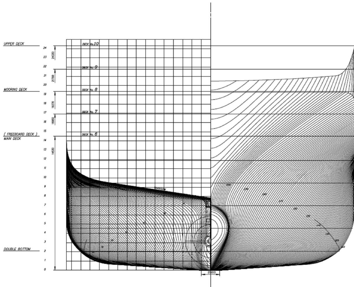
Slika 28. Poprečni presjek
