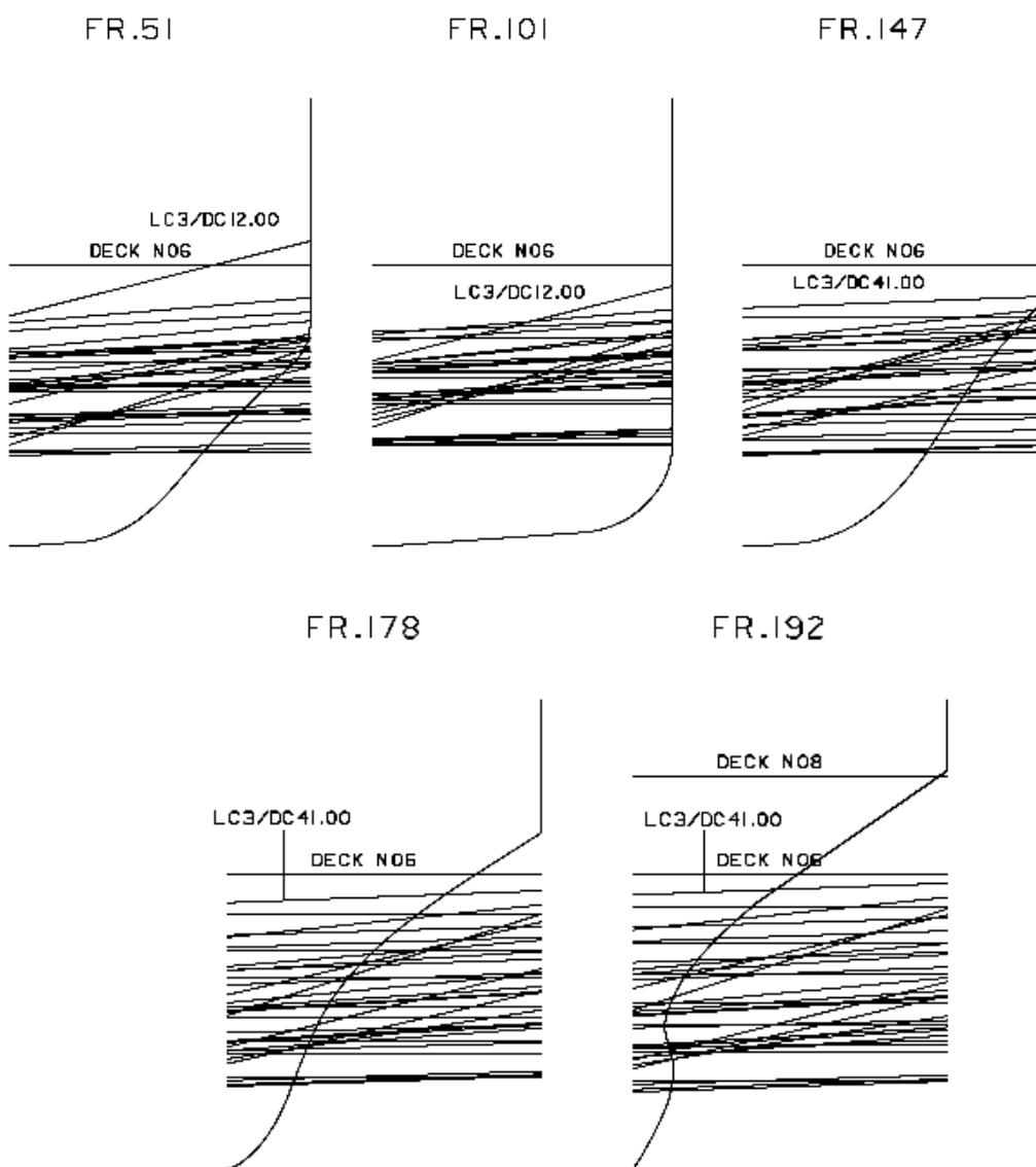
Slika 42. Vodne linije za pojedine slučajeve oštećenja
