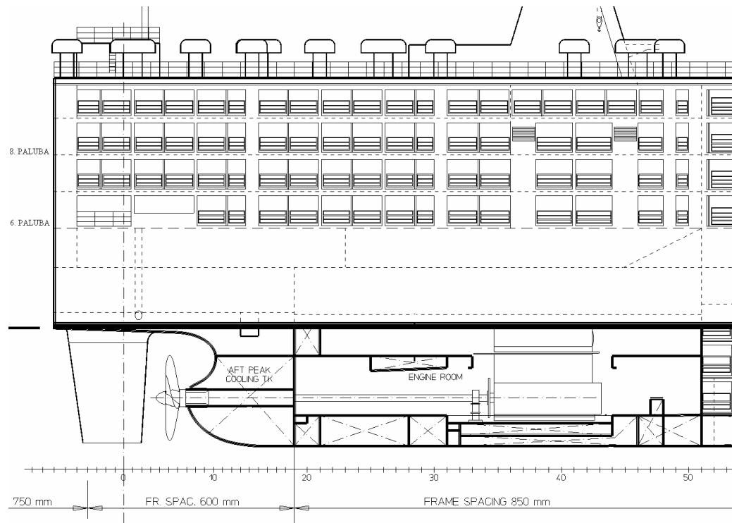
Slika 31. Gradnja 428 - prikaz otvorenog boka iznad 6. palube
