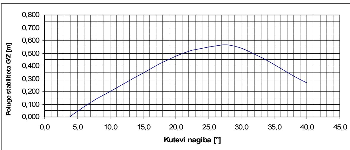
**Slika 39. Poluge stabiliteta u oštećenom stanju za slučaj 311.00 na gazu  $d_p = 7,089 \text{ m}$**
