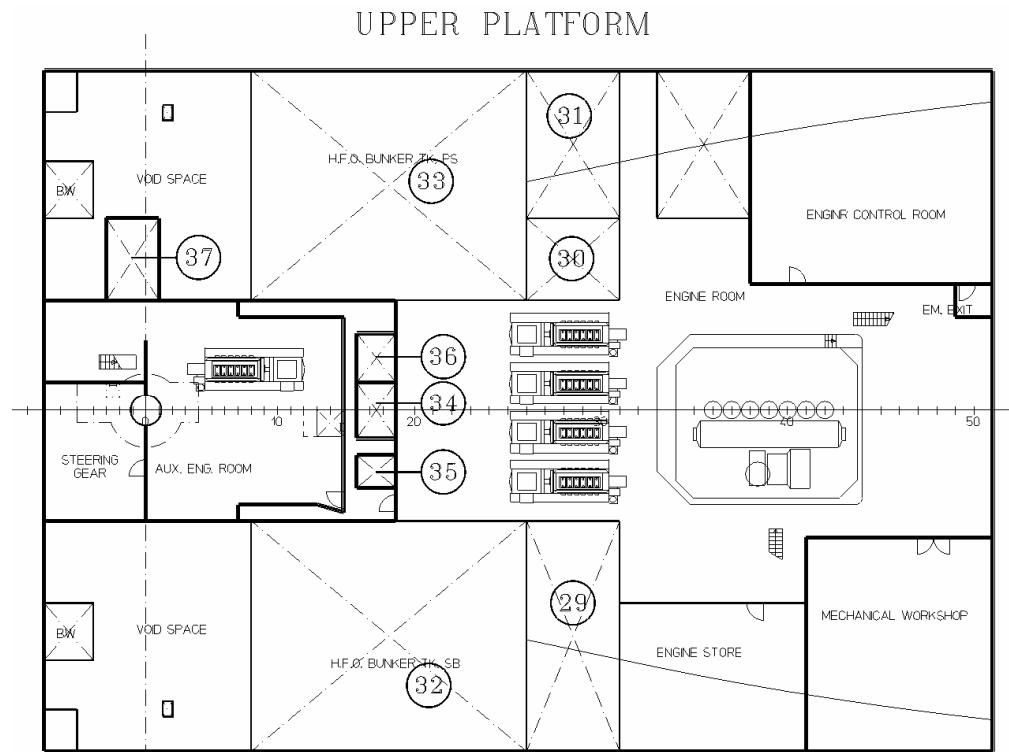
**Slika 21. Tankovi gornje platforme strojarnice gradnje 428 – skladišni tankovi teškog goriva te dnevni i taložni tankovi teškog goriva smješteni uz vanjsku oplatu**
