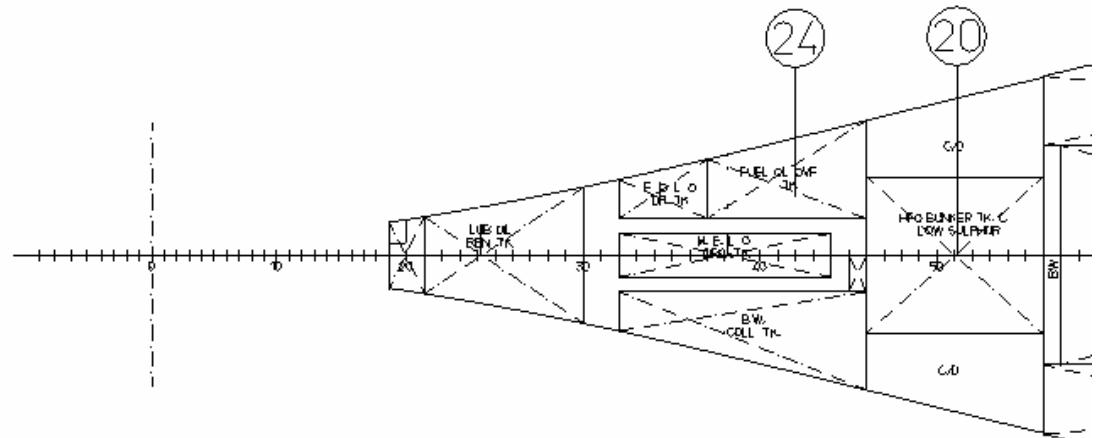
Slika 24. Tankovi goriva dvodna i tankovi teškog goriva od pokrova dvodna do 5. palube - projekt
