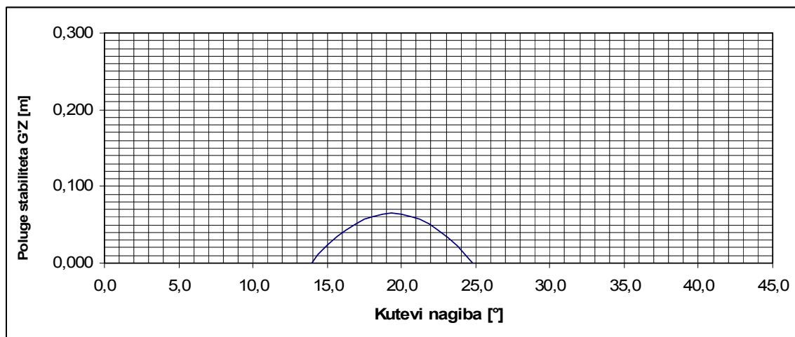
**Slika 38. Poluge stabiliteta u oštećenom stanju za slučaj 12.00 na gazu  $d_s = 8,461$  m****Stabilitet u oštećenom stanju za gaz  $d_p = 7,089$  m****Tablica 42. Minimalne metacentarske visine za gaz  $d_p$**
