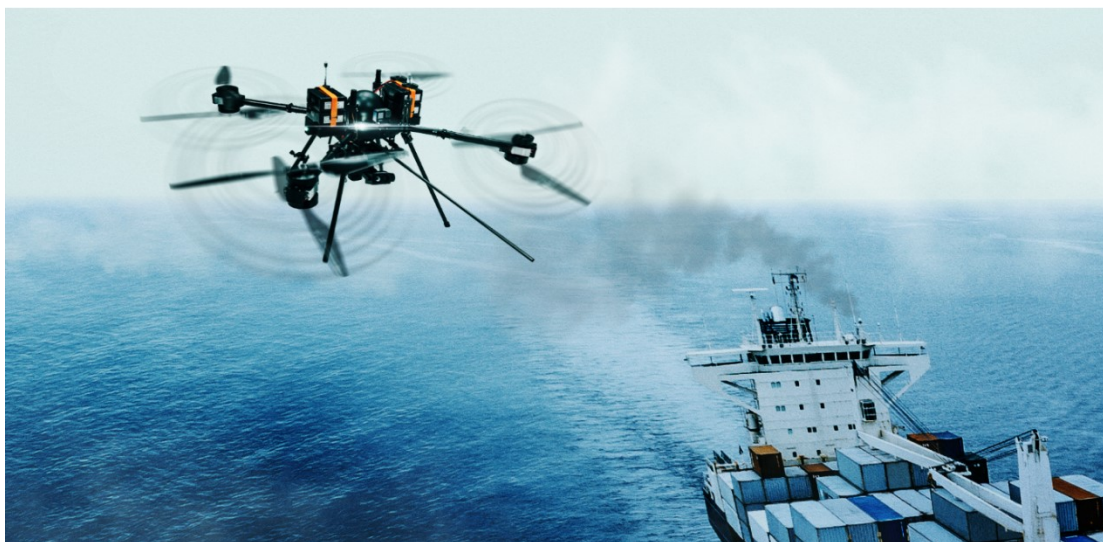
Slika 10. Besposadna višerotorna letjelica Staaker [23]
