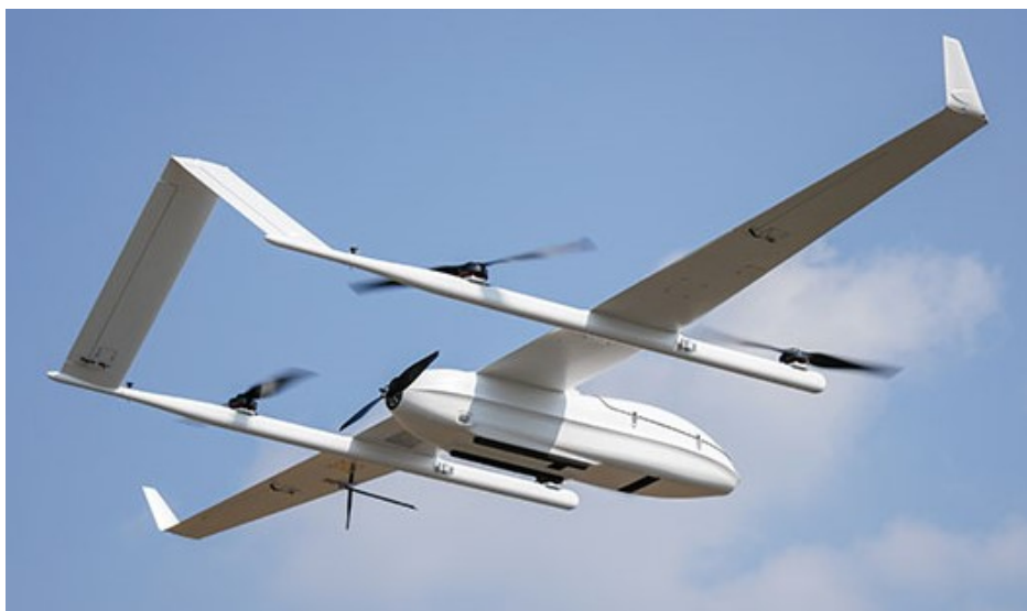
Slika 9. Primjer hibridne besposadne letjelice - CW-25E tvrtke JOUAV [22]
