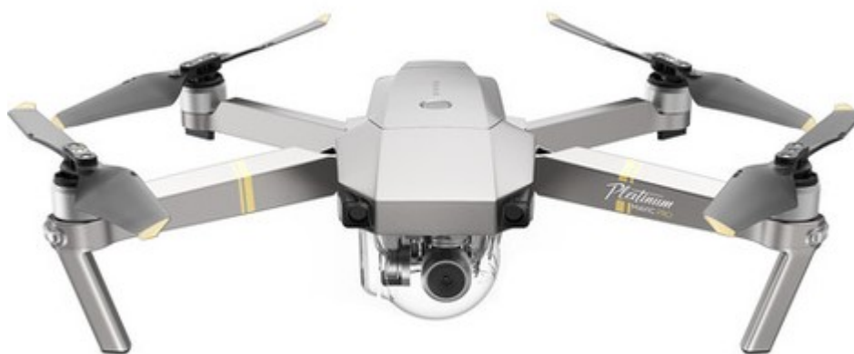
Slika 6. Primjer беспilotne letjelice s više rotora - Mavic Pro Platinum tvrtke DJI [19]
