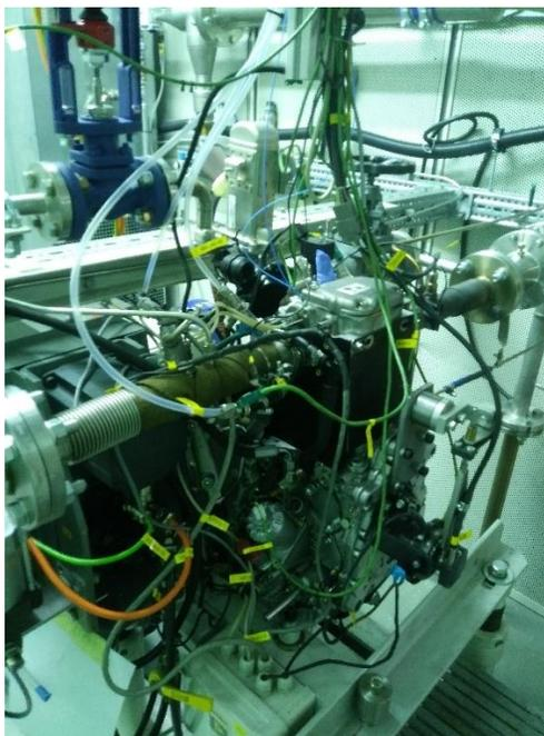
Slika 1. Ispitni motor Hatz 18D1 u laboratoriju FSB-a
