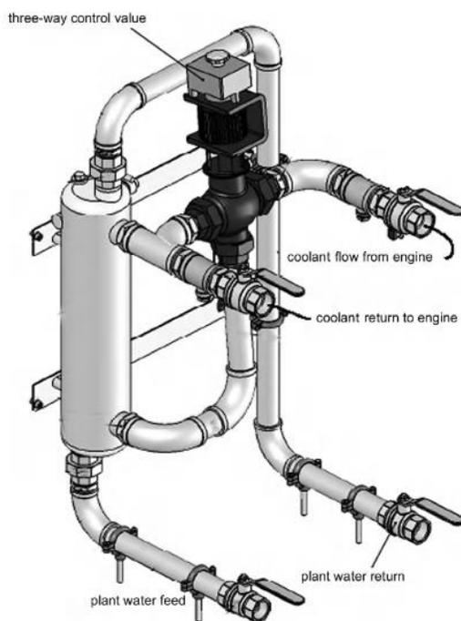
Slika 22. Zidni uređaj za regulaciju rashaldne tekućine
