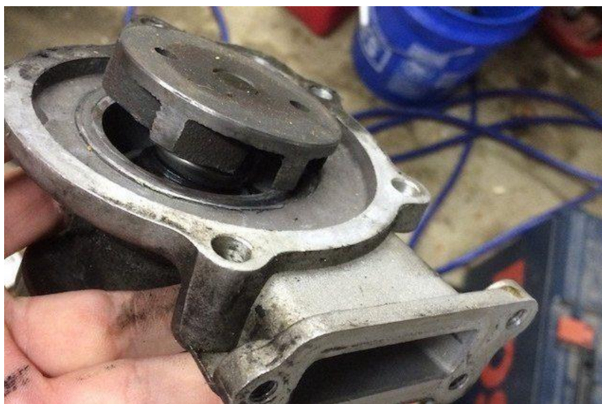
Slika 14. Polomljen mehanizam pogona pumpe [20]
