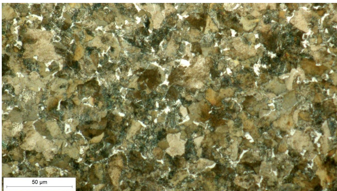
Slika 53. Mikrostruktura u oštrici mačete, snimljena pri povećanju 500×
