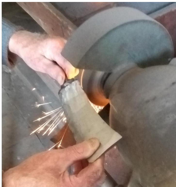
Slika 35. Poravnanje plohe nasuprotne oštrici mačete
