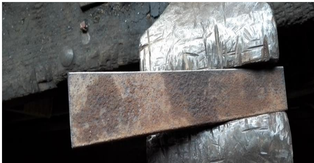
Slika 22. Izrezani uzorak prije kovanja
