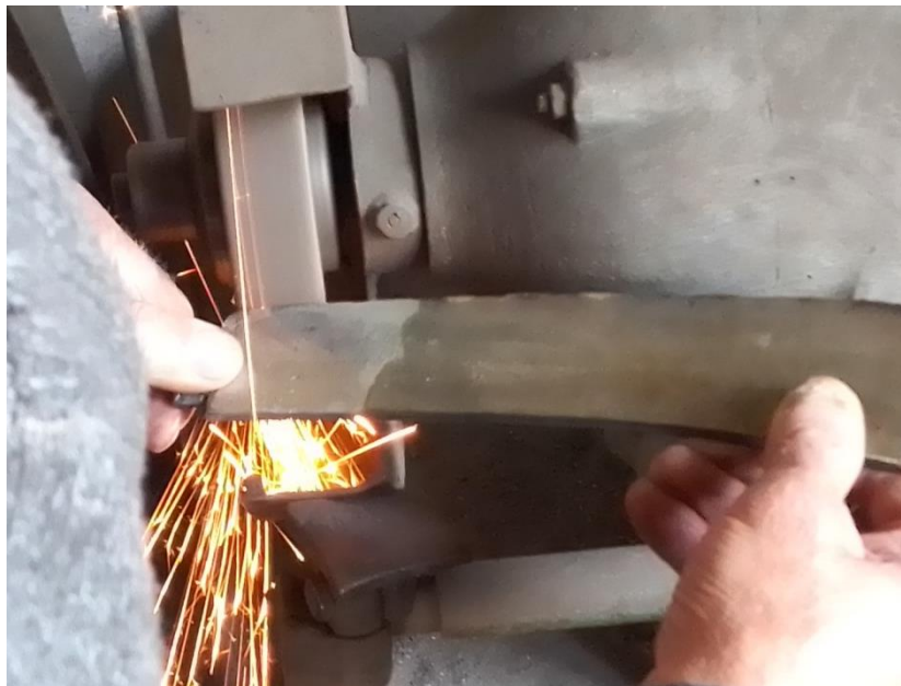
Slika 34. Poravnanje oštrice mačete na stolnoj brusilici
