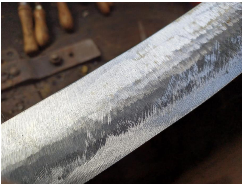
Slika 36. Oštrica mačete nakon oštrenja turpijom
