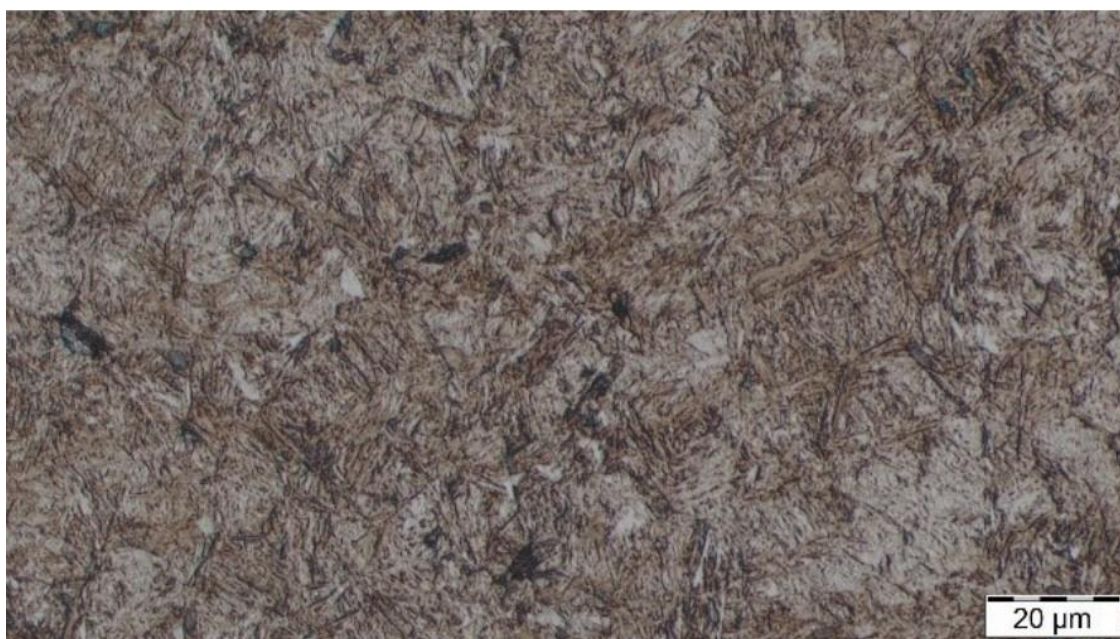
Slika 56. Mikrostruktura gašenog čelika 55Cr3 za brzinu gašenja od 10 °C/s [20]
