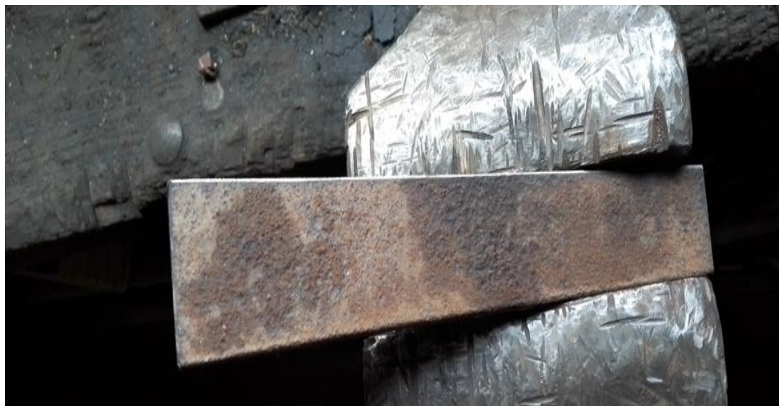
Slika 22. Izrezani uzorak prije kovanja
