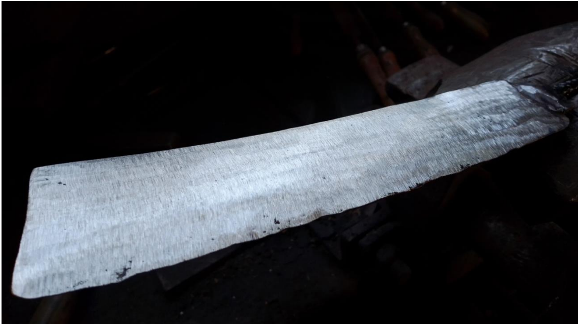
Slika 32. Mačeta nakon finog brušenja
