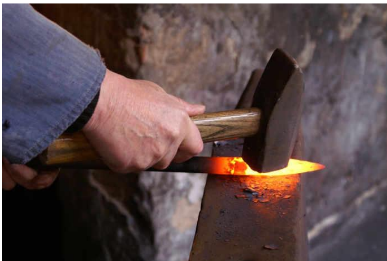
Slika 4. Kovanje upotrebom nakovnja i čekića [7]
