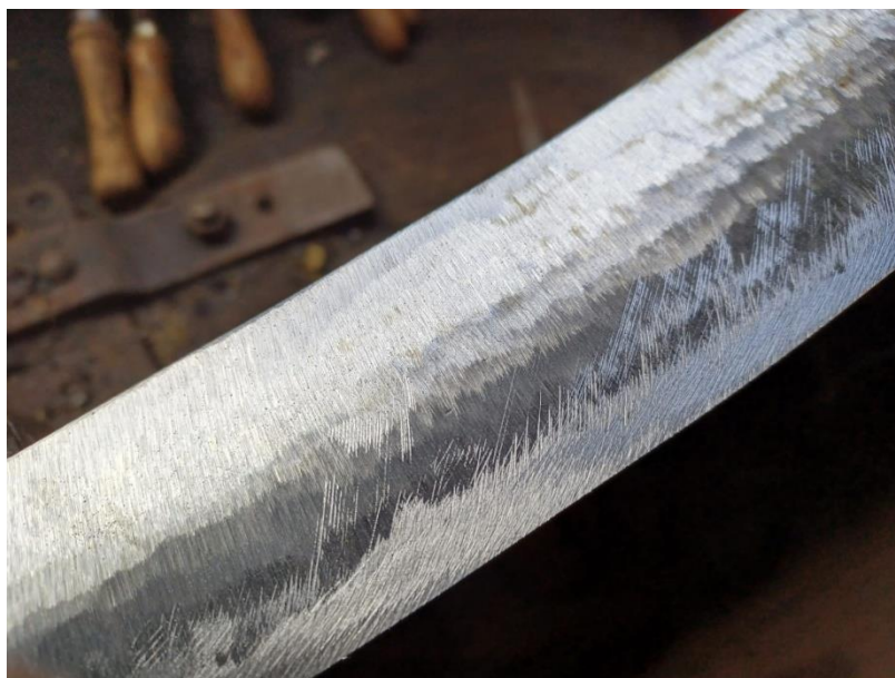
Slika 36. Oštrica mačete nakon oštrenja turpijom
