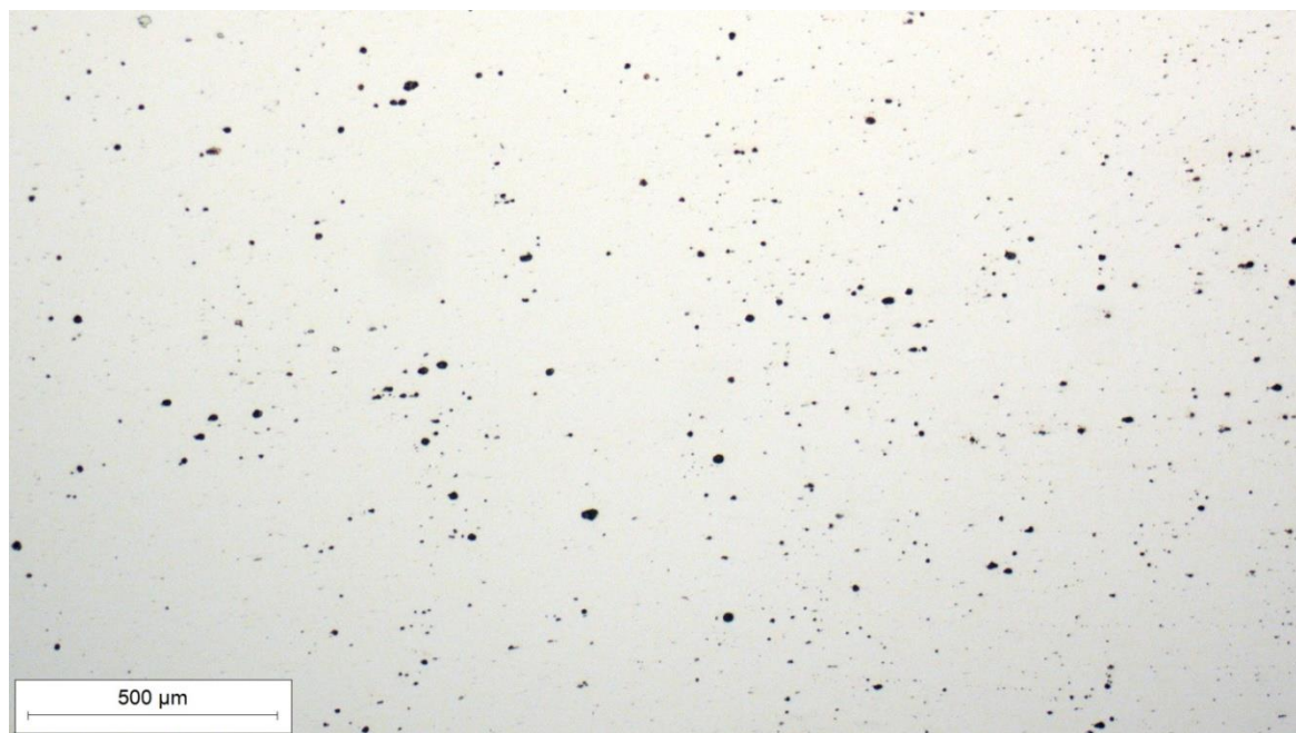
Slika 44. Mikrostruktura poprečnog presjeka mačete u sredini, snimljeno pri povećanju 50×
