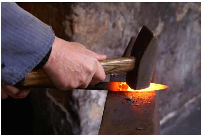
Slika 4. Kovanje upotrebom nakovnja i čekića [7]
