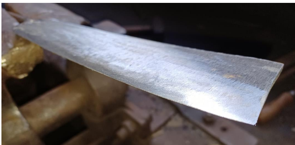
Slika 37. Oštrica mačete nakon završnog oštrenja brusnim papirom
