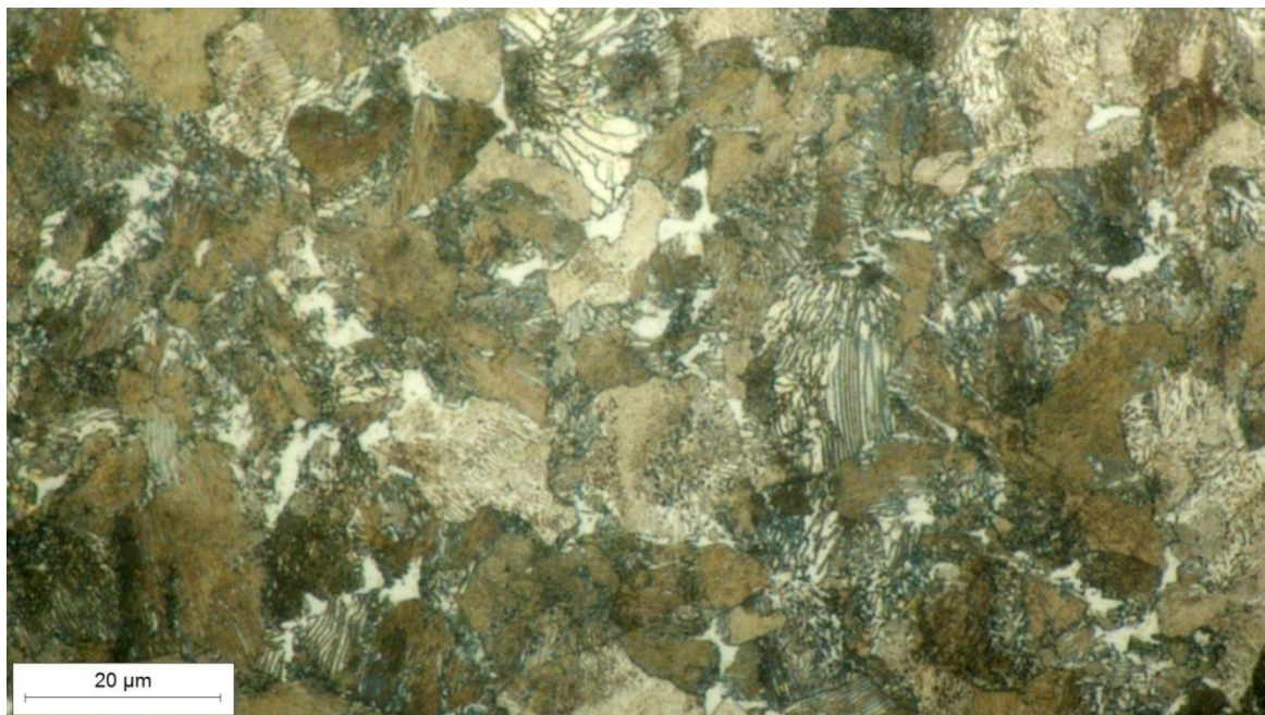
Slika 52. Mikrostruktura mačete u sredini poprečnog presjeka, snimljeno pri povećanju 1000×
