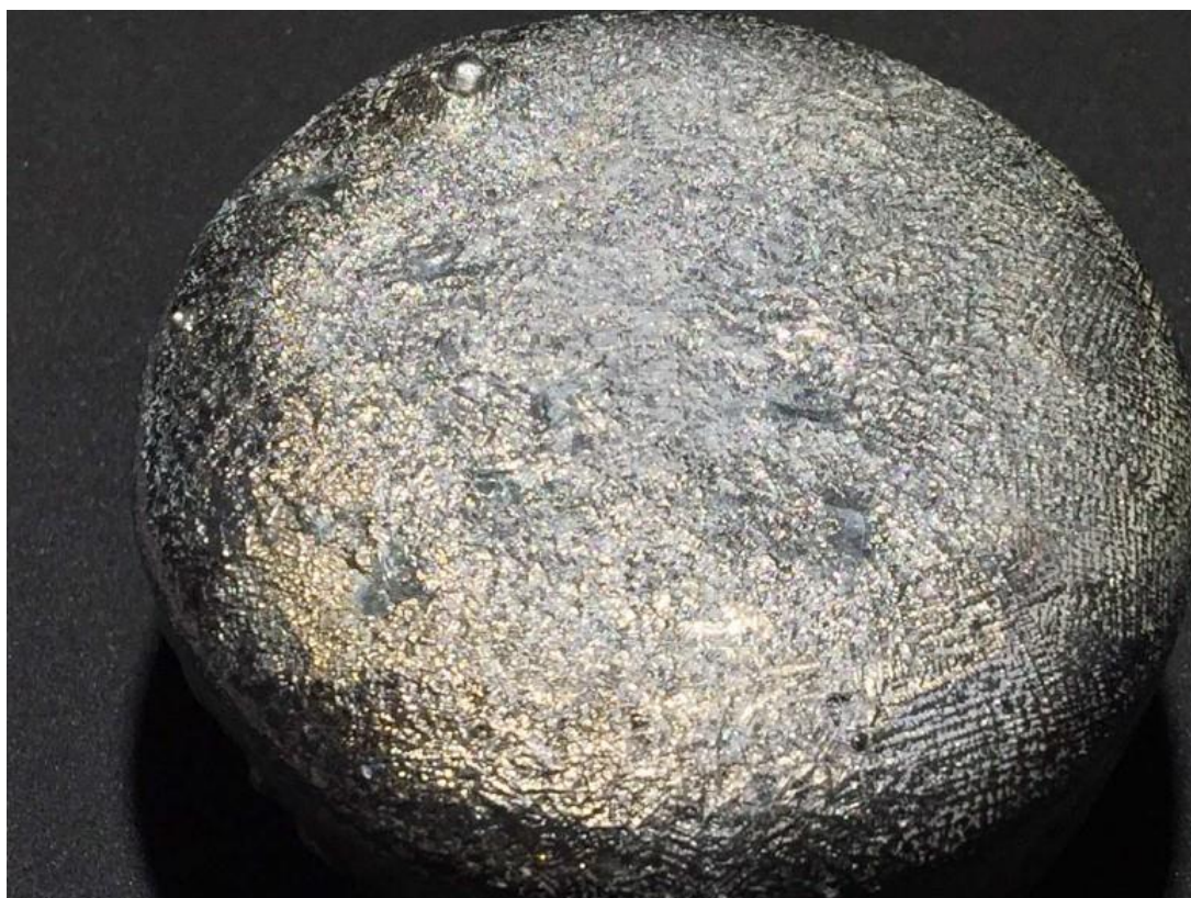
Slika 8. Odljevak wootz čelika[10]
