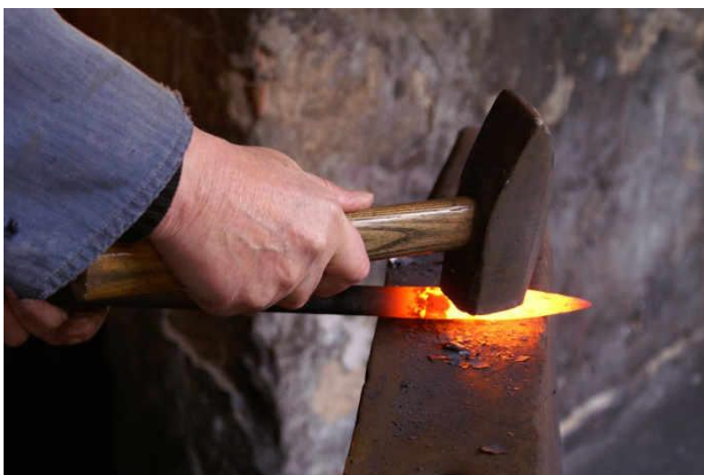
Slika 4. Kovanje upotrebom nakovnja i čekića [7]
