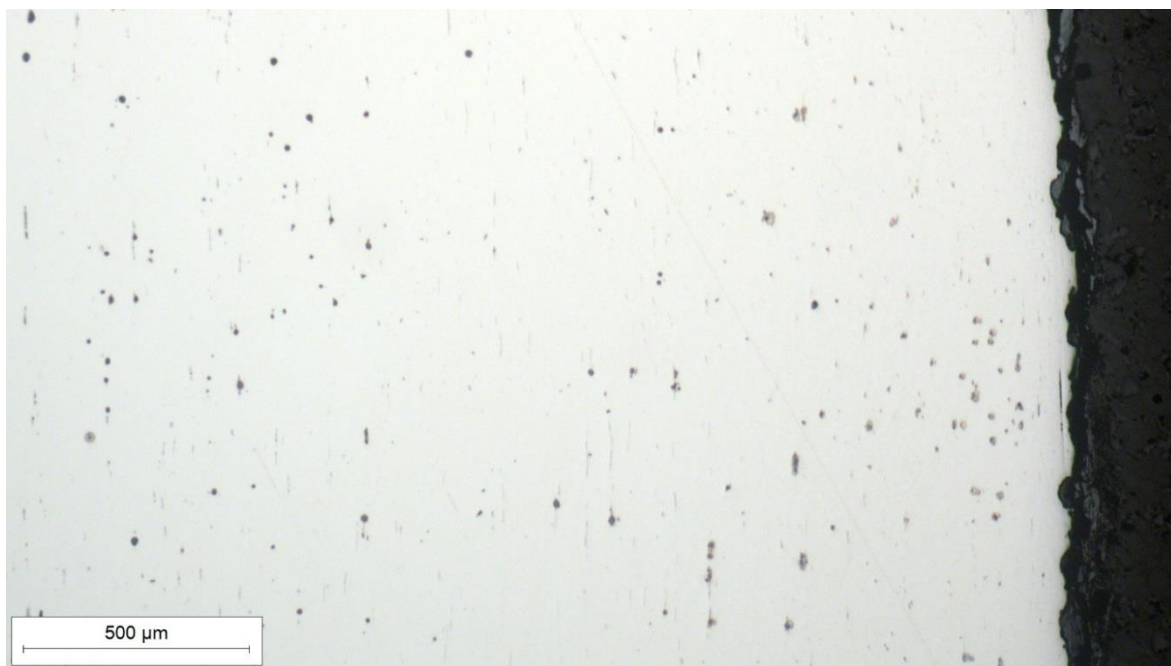
Slika 42. Mikrostruktura osnovnog materijala prije kovanja u poliranom stanju (desni rub) snimljena pri povećanju 50×
