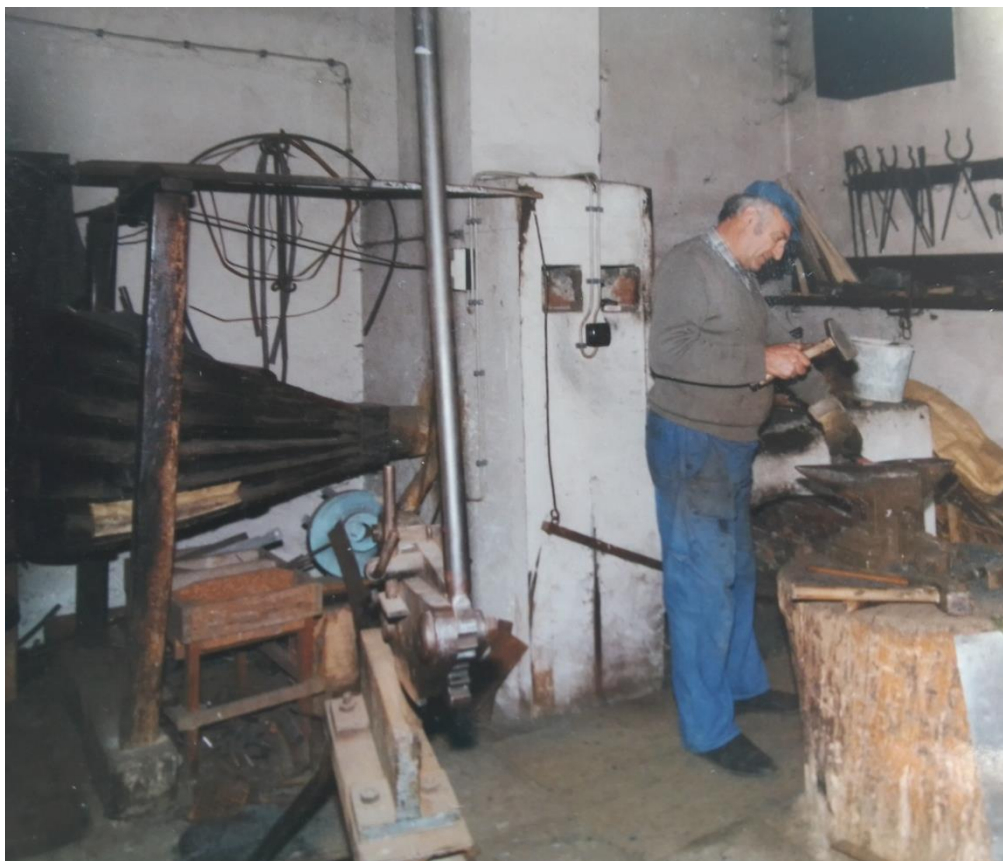
Slika 6. Prikaz kovača i kovačkog mijeha
