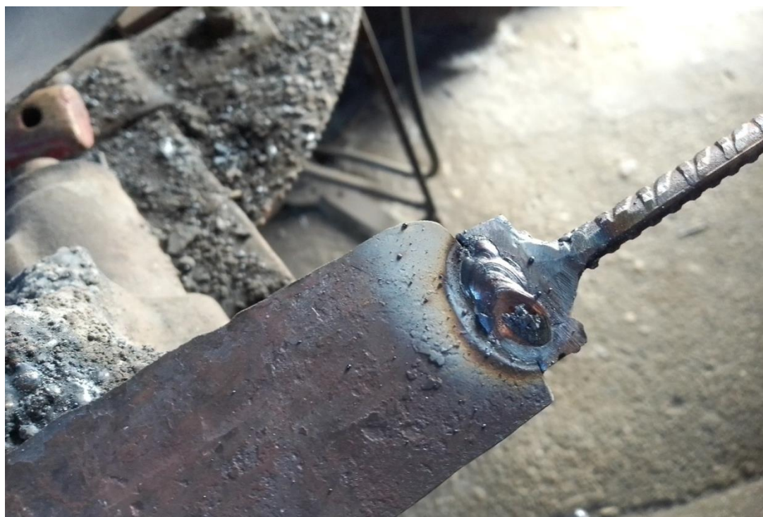
Slika 29. Prikaz zavara na otkivku
