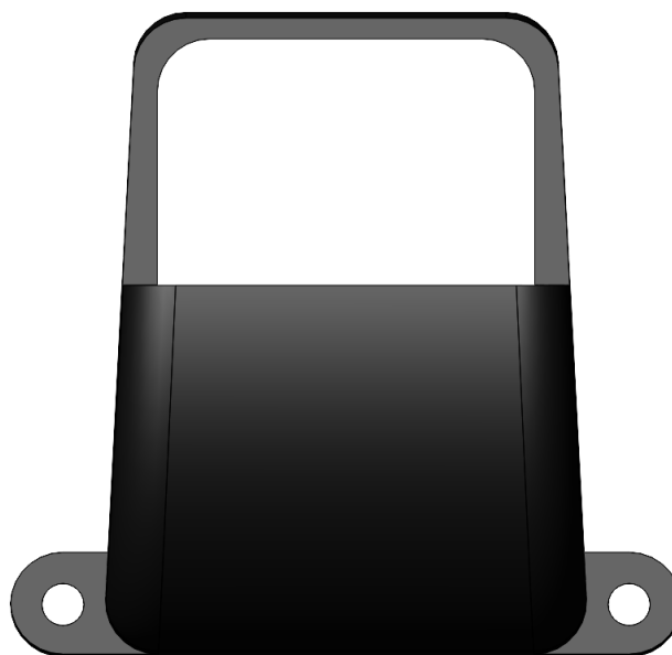
Slika 93. Prikaz poklopca za zaštitu izrađen ljevačkim kutom od 3 stupnja
