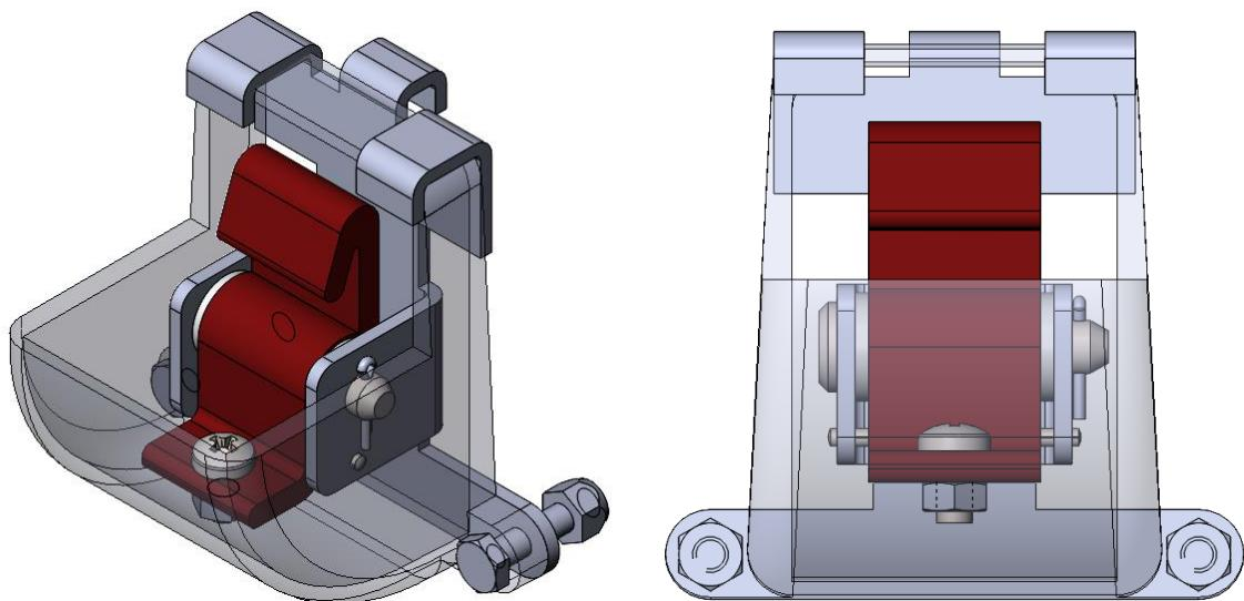
Slika 75. Prikaz unutrašnjih komponenti donjeg dijela sklopa u izometriji (lijevo) i nacrtu (desno)
