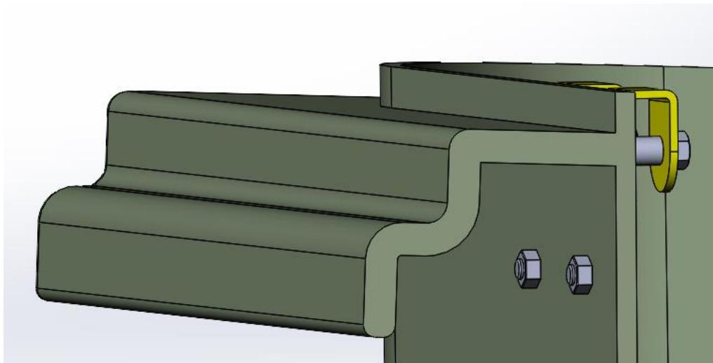
**Slika 53. Prikaz montaže matica zaštićenih prednjim dijelom spremnika**
