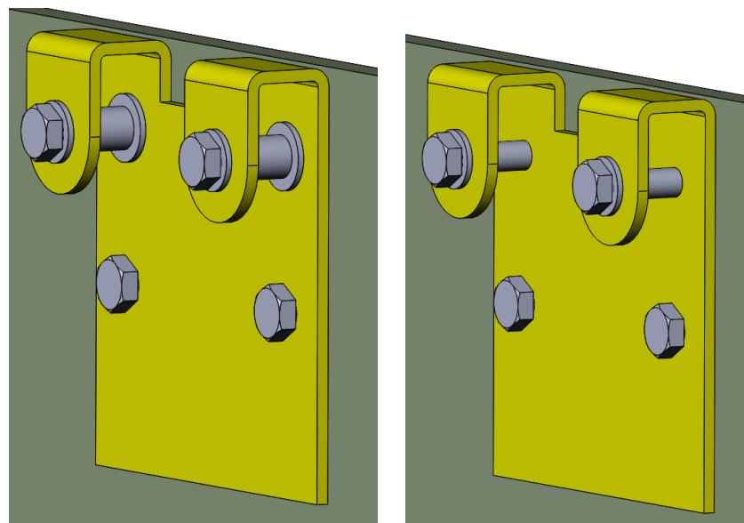
Slika 51. Prikaz lima s vijcima s kliznim ležajevima (lijevo) i bez njih (desno)
