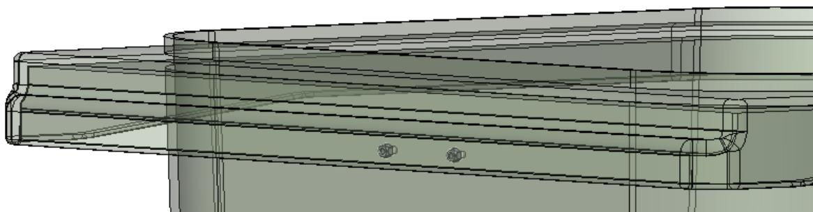
**Slika 81. Prikaz rasporeda matica za pričvršćivanje u izometriji**
